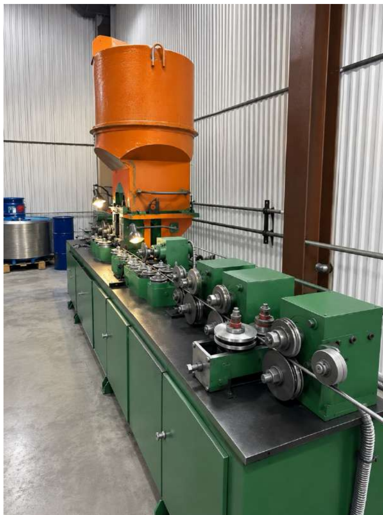
Рисунок 3.1 Линия по производству порошковой проволоки ООО «Энерго Системы Про»
