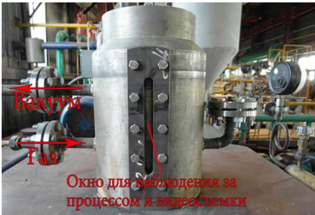
Рисунок 4.13 Лабораторный СВС Реактор в ООО «НТПФ Эталон»
