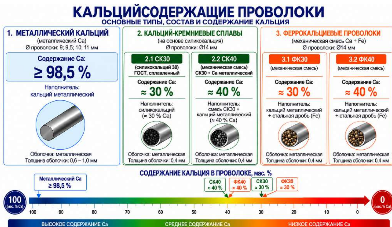
Рисунок 1.3 Классификация видов кальцийсодержащей порошковой проволоки
