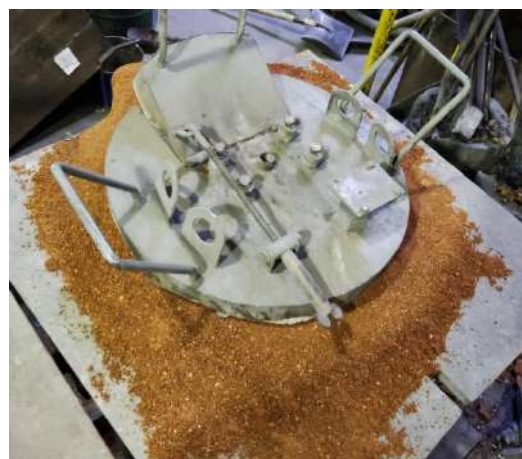
Рисунок 3.5 Индукционная печь, защитная крышка (слева) Положение при обработке.
