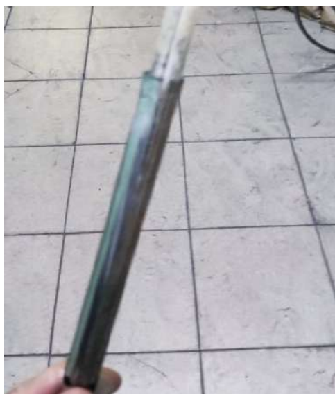
Рисунок 3.6 Порошковая проволока с модификатором.
