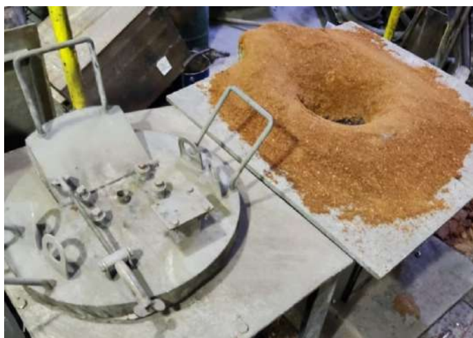
Рисунок 3.4 Индукционная печь, защитная крышка (слева) Положение при выплавке.
