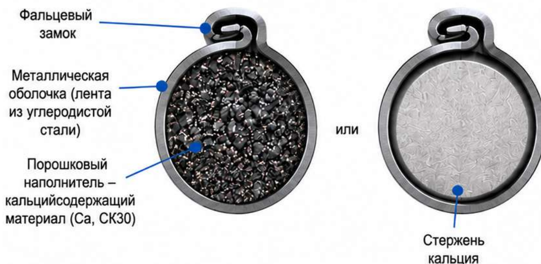
Рисунок 1.2 - Конструкция кальцийсодержащей порошковой проволоки
