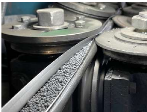
Рисунок 3.10 - производство проволоки с кальцием металлическим гранулированным
