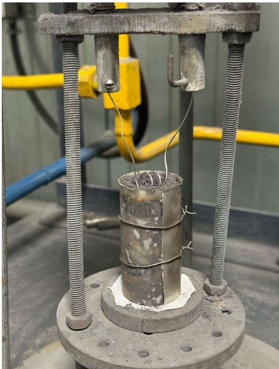
Рисунок 4.14 Тигель с установленной нихромовой спиралью закрепленный для установки в лабораторный реактор
