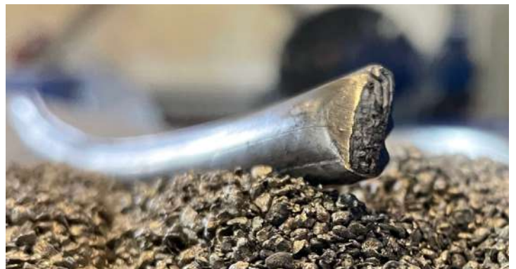
Рисунок 3.10 - производство проволоки с кальцием металлическим гранулированным
