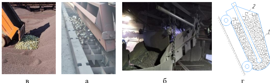
Рисунок 5 – Логистика замасленной окалины (а – выгрузка из вагона-хоппера в бункер; б – выгрузка из бункера с вибрационным питателем на пластинчатый конвейер; в – выгрузка в ЦПАШ; г – схематичное размещение материалов в скипе: 1 – железорудное сырье; 2 – металлический контейнер с замасленной окалиной)
