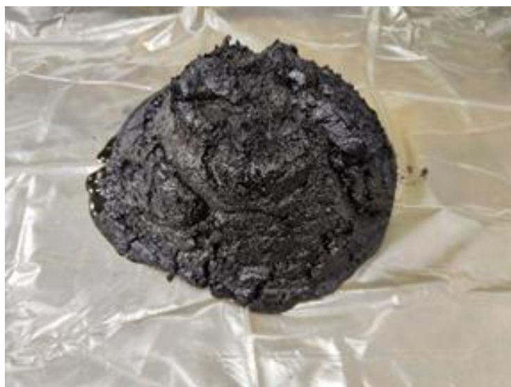
Рисунок 2.1 – Штабель для оценки скорости испарения влаги из замасленной окалины в лабораторных условиях
