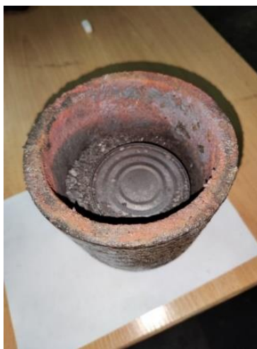
Рисунок 3.8 – Металлический контейнер с окалиной в присутствии избытка кокса
