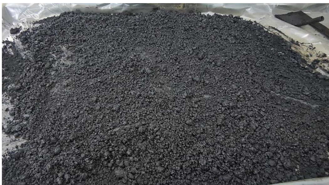
Рисунок 2.2 – Замасленная окалина после естественной сушки
