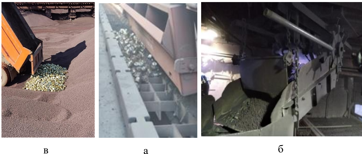
Рисунок 4.6 – Логистика замасленной окалины (а – выгрузка из вагона-хоппера в бункер; б – выгрузка из бункера с вибрационным питателем на пластинчатый конвейер; в – выгрузка в ЦПАШ
