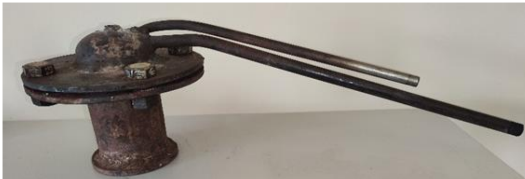
Рисунок 3.3 – Реактор для моделирования процессов, протекающих внутри металлического контейнера
