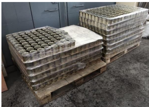
Рисунок 4.5 – Замасленная окалина, упакованная в металлические контейнеры в количестве 1 тонна
