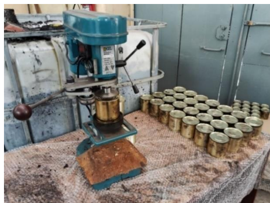
Рисунок 4.4 – Процесс упаковки замасленной окалины
