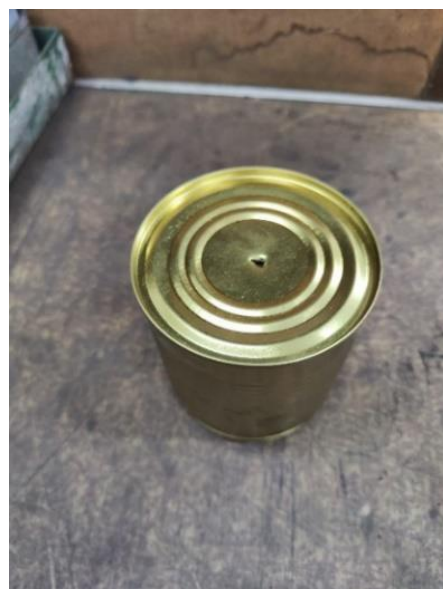
Рисунок 2.7 – Контейнерная упаковка размерами 85x83,4 мм с технологическим отверстием
