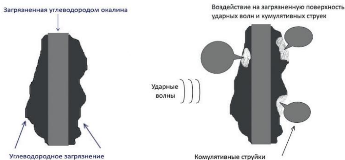
Рисунок 1.4 – Первичная загрязненная частица окалины и начало процесса очистки
