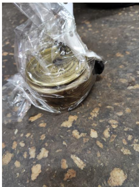
Рисунок 2.9 –Металлический контейнер, расположенный вертикально, выдерживает давление в среднем до 3923 кПа - холодная прочность
