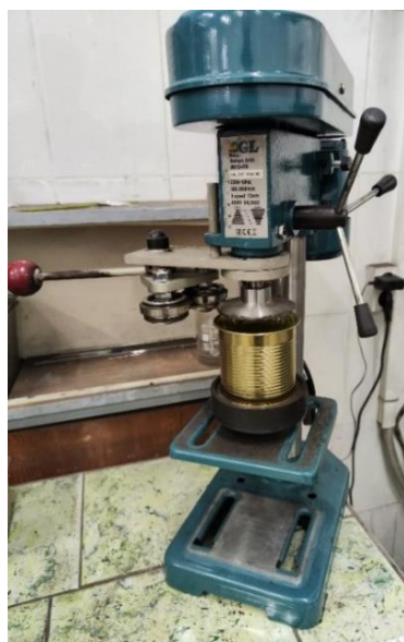
Рисунок 2.6 – Установка для закатки контейнерной упаковки с замасленной окалиной
