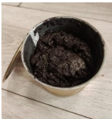
Рисунок 4.3 – Замасленная окалина однородной консистенции
