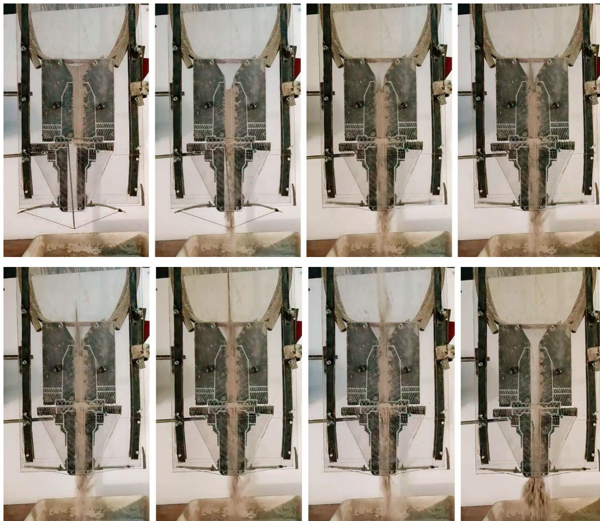
Рисунок 2.16 – Картина процесса взаимодействия стрелы катапульты с малым лобовым сопротивлением при хрупком слое перемычки на входе в выпускной канал модели ковшового затвора
