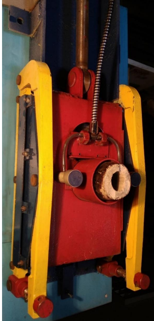
Рисунок 4.6 – Опытный образец затвора, снабженный системой вибрационного воздействия на детали его огнеупорного комплекта
