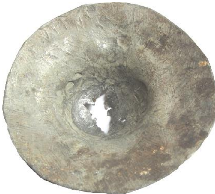
Рисунок 2.8 – Характер разрушения свинцового имитатора перемычки толщиной 0,5 мм для канала диаметром 80 мм
