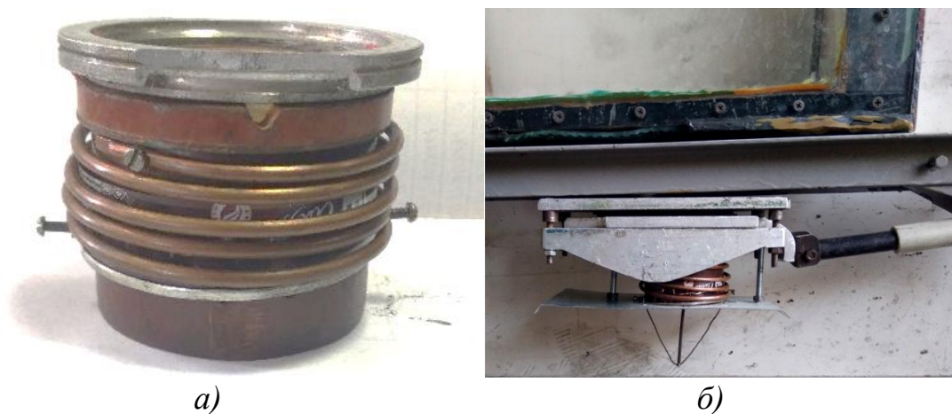
Рисунок 4.9 – Конструктивное исполнение силового узла катапульти (а) и относительное положение ее элементов во взведенном (б) состоянии после установки на модель
