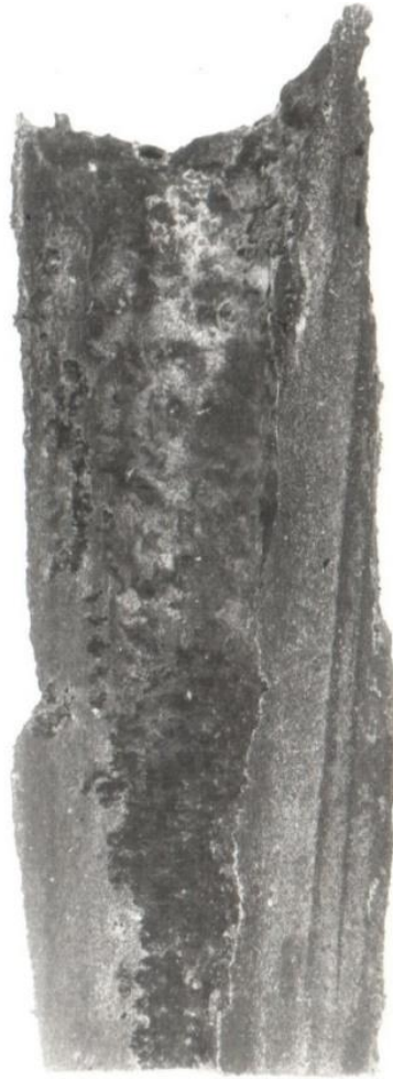
Рисунок 1.19 – Продольный разрез настыли, образовавшейся в канале разливочного стакана при его зарастании
