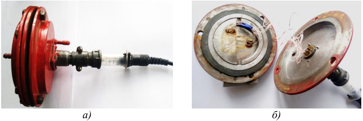
Рисунок 2.4 – Внешний вид тензорезисторного преобразователя давления (а) и размещение в нем рабочих и компенсационных датчиков (б)
