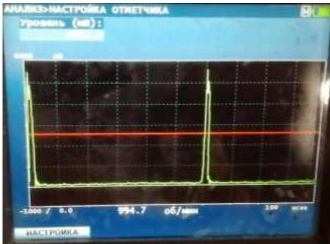
Рисунок В.5. Пиковые значения изменения скорости вращения вала двигателя привода нижних (гладких) валков дробилки ДЧГ 900×700 в процессе дробления кокса сухого тушения
