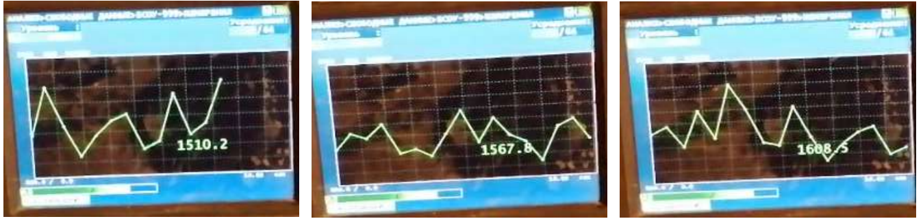
Рисунок Г.3. Перемещение нижнего неприводного валка при дроблении кокса сухого тушения (предварительная затяжка пружин амортизаторов X = 0,02 м)
