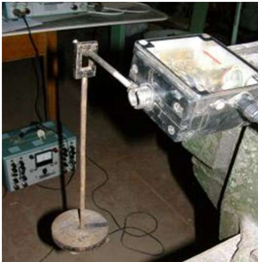
Рисунок 2.11. Процесс тарировки тензорезисторного преобразователя
