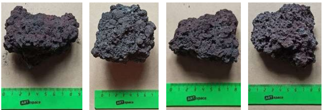
Рисунок 2.5. Образцы для проведения исследований прочности агломерата в холодном состоянии
