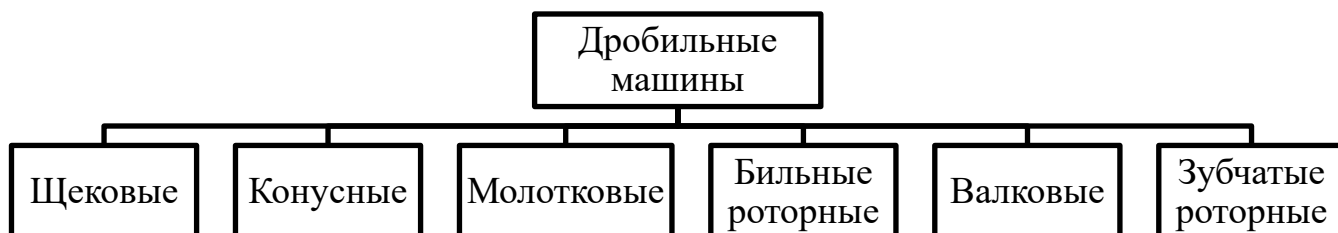
Рисунок 1.3. Уточненная классификация дробильных машин
