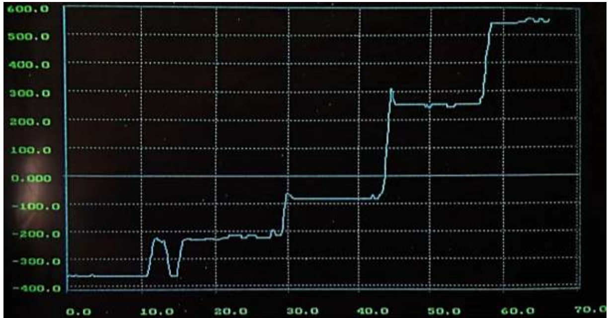
Рисунок Б.1. График значений цифрового выхода сигнала АЦП при тарировке тензорезисторного преобразователя
