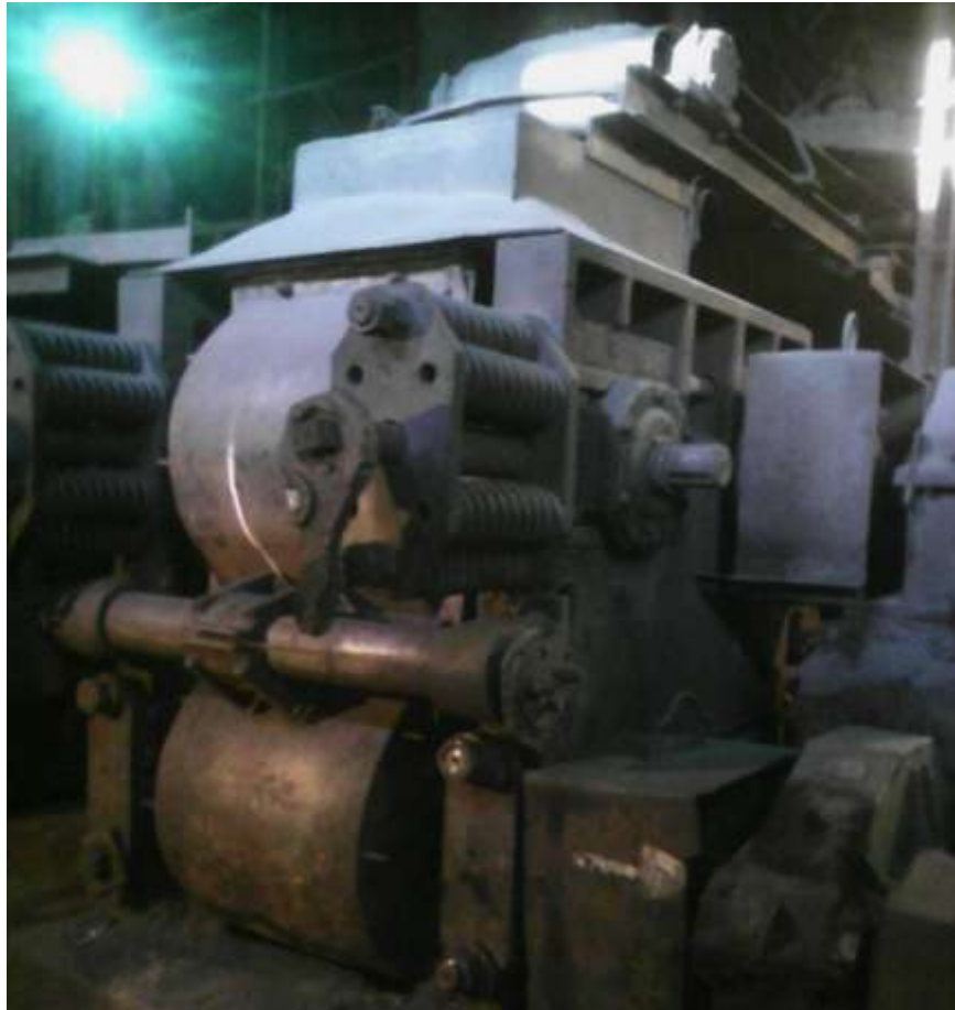
Рисунок 2.17. Четырехвалковая дробилка ДЧГ 900×700 (б) в условиях агломерационного цеха «АМК» ООО «ЮГМК»
