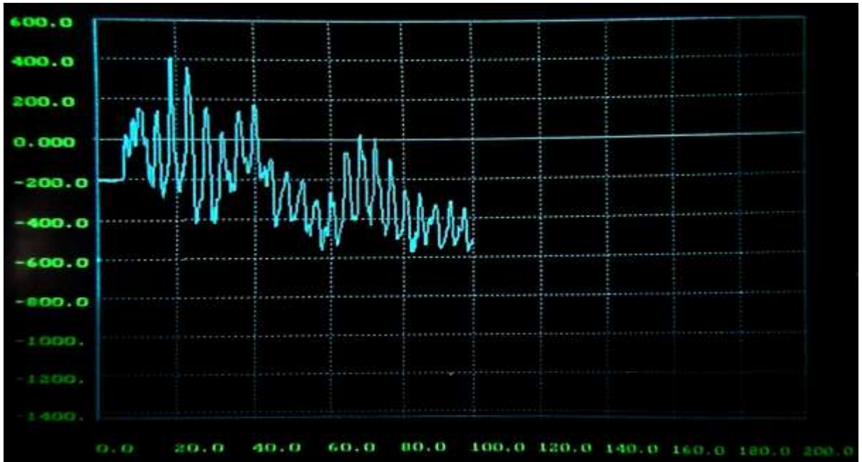
Рисунок Б.5. График значений цифрового выхода сигнала АЦП при дроблении образца пенопласта длиной 0,11 м в дробилке с ротором спирального типа
