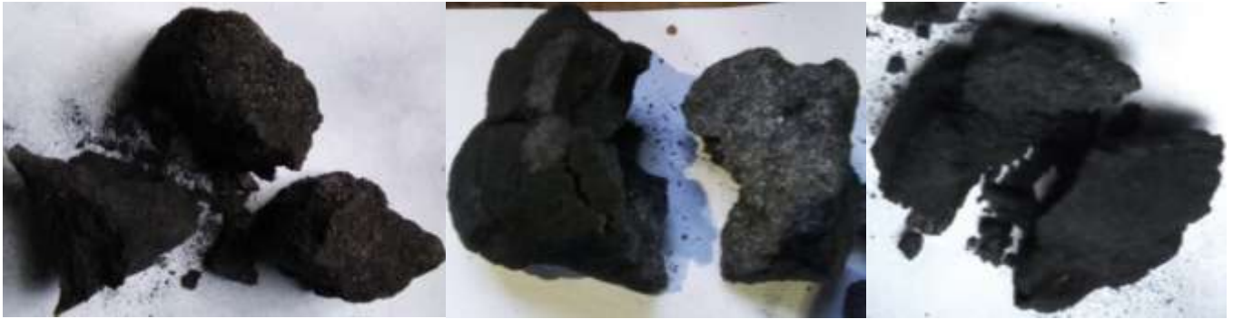
Рисунок 5.26. Образцы твердого топлива естественной (неправильной) характерной формы после разрушения одноосным сжатием
