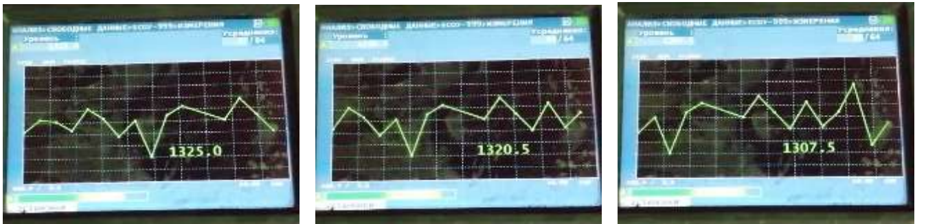
Рисунок Г.4. Перемещение нижнего неприводного валка при дроблении кокса сухого тушения (предварительная затяжка пружин амортизаторов X = 0,025 м)
