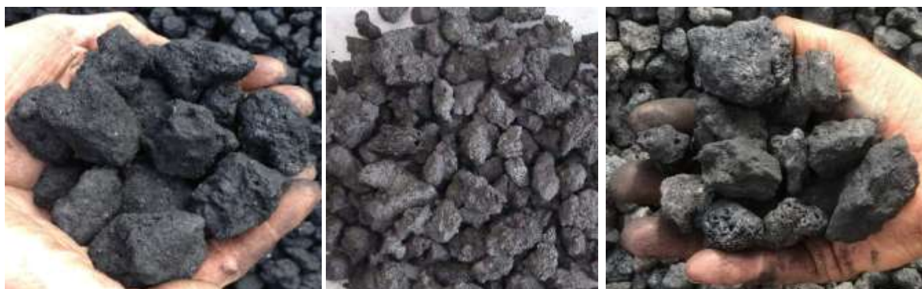
Рисунок 5.25. Различные виды металлургического кокса, используемого в технологическом процессе в условиях агломерационного цеха «АМК» ООО «ЮГМК»
