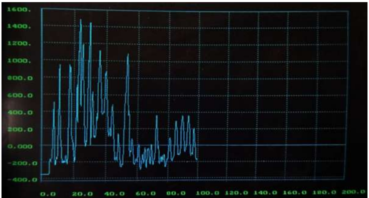
Рисунок Б.6. График значений цифрового выхода сигнала АЦП при дроблении образца гипсокартонной плиты в дробилке с ротором спирального типа
