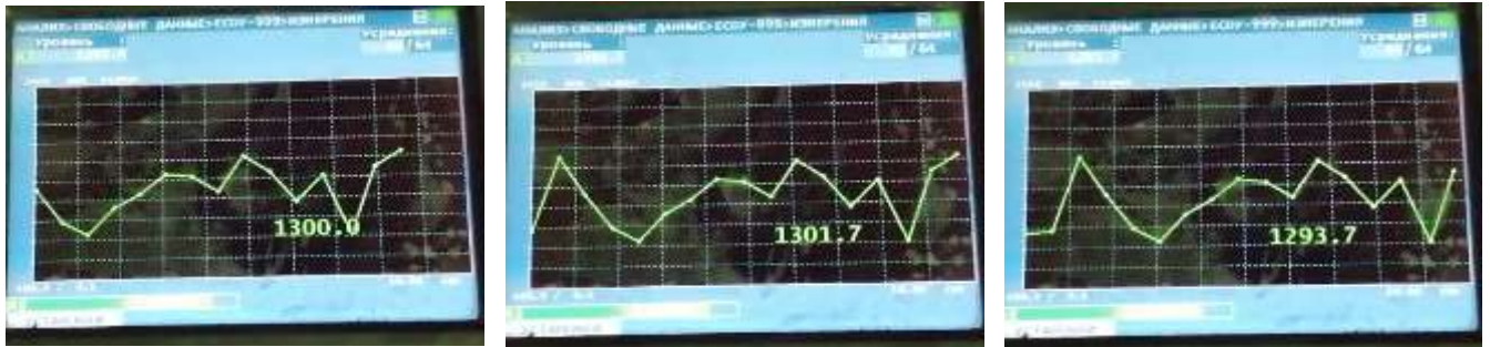
Рисунок Г.1. Перемещение нижнего неприводного валка при дроблении кокса сухого тушения (предварительная затяжка пружин амортизаторов X = 0,001 м)
