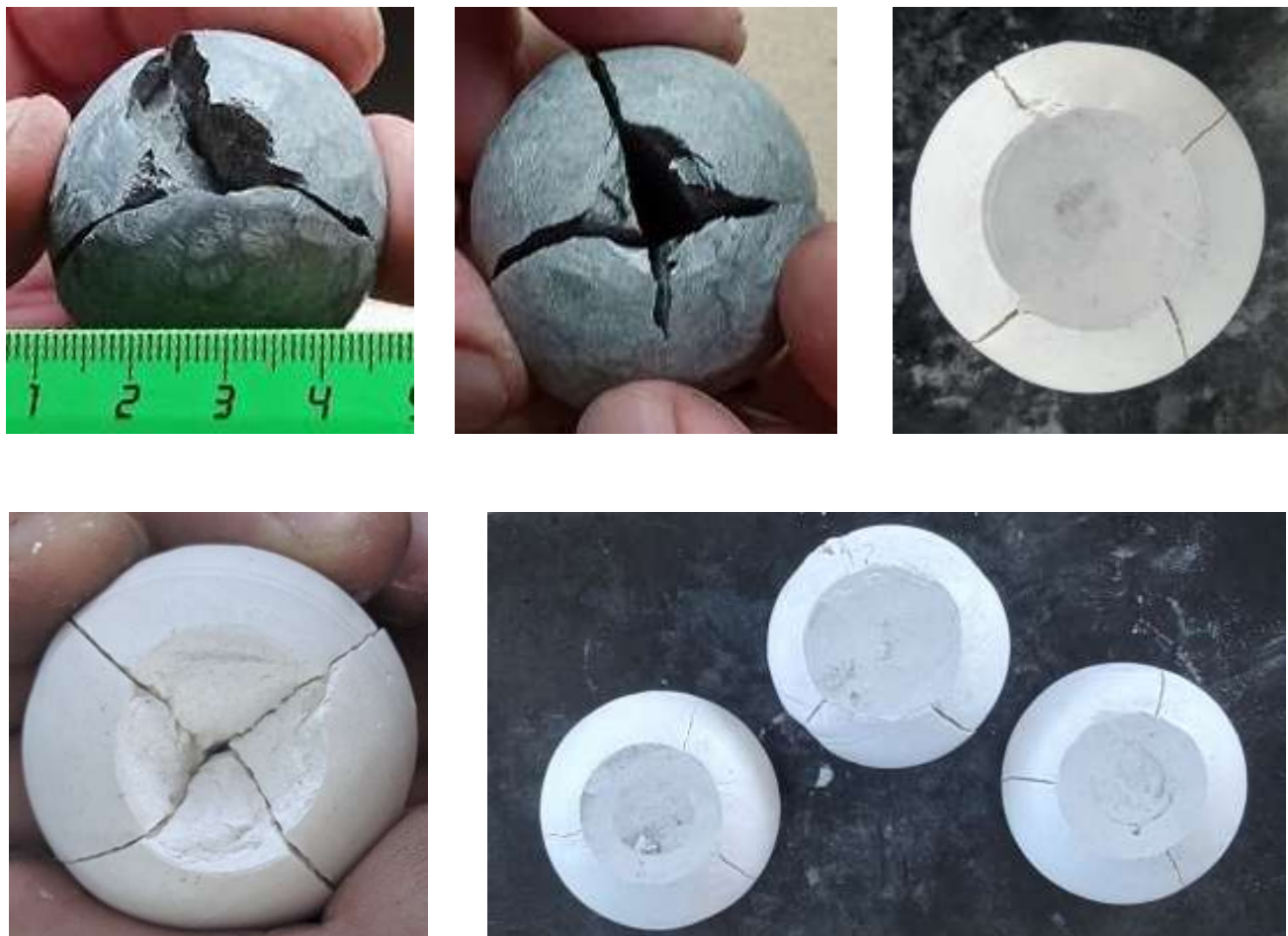
Рисунок 3.9. Характерная форма разрушения образцов материалов деформацией одноосного сжатия
