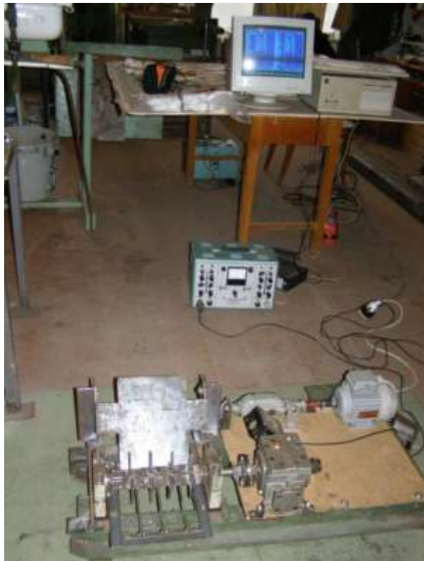
Рисунок 2.8. Лабораторный стенд для исследования энергосиловых параметров процесса дробления в роторной зубчатой дробилке
