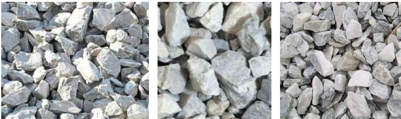
Рисунок 6.15. Характерный вид отдельных кусков известняка флюсового, используемого в условиях агломерационного цеха «АМК» ООО «ЮГМК»
