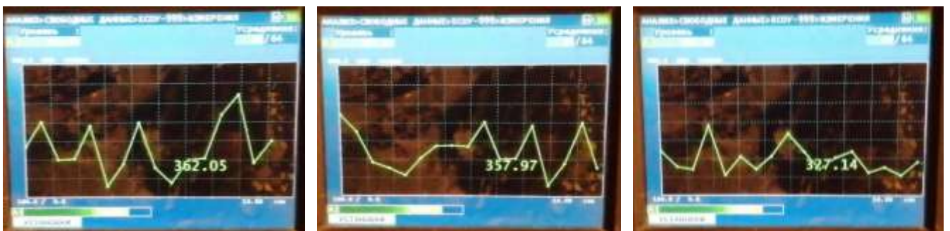
Рисунок Г.5. Перемещение верхнего неприводного валка при дроблении кокса сухого тушения (предварительная затяжка пружин амортизаторов X = 0,005 м)
