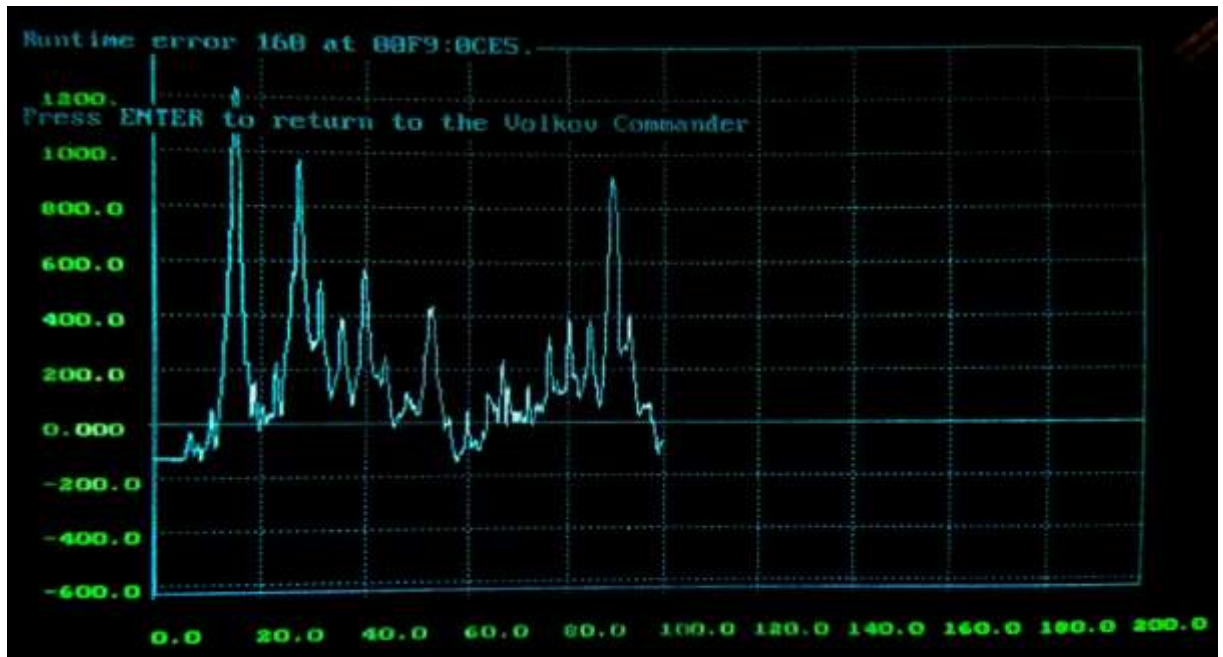
Рисунок Б.3. График значений цифрового выхода сигнала АЦП при дроблении образца пенопласта длиной 0,11 м в дробилке с ротором линейного типа
