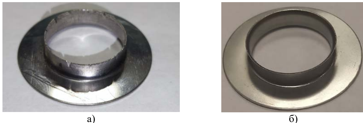
Рисунок 7 – Внешний вид отсекаателя, изготовленного по: а – существующей схеме переходов со штамповкой бурта (присутствуют нарушения сплошности на бурте); б) – модернизированной схеме деформирования с раскаткой бурта (дефекты отсутствуют)
