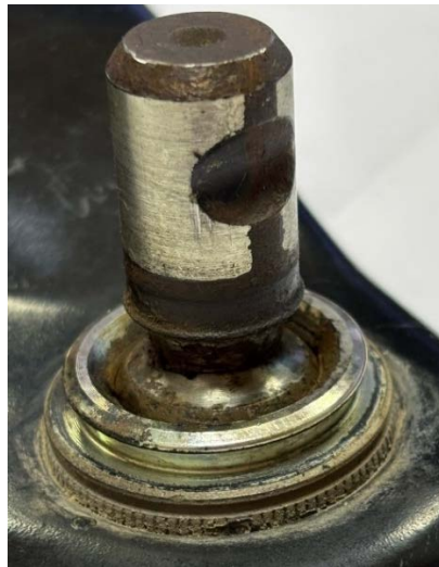
Рисунок 1.3 – Внешний вид возвращенного из эксплуатации шарового шарнира передней подвески автомобиля LADA Largus с дефектом «стук»
