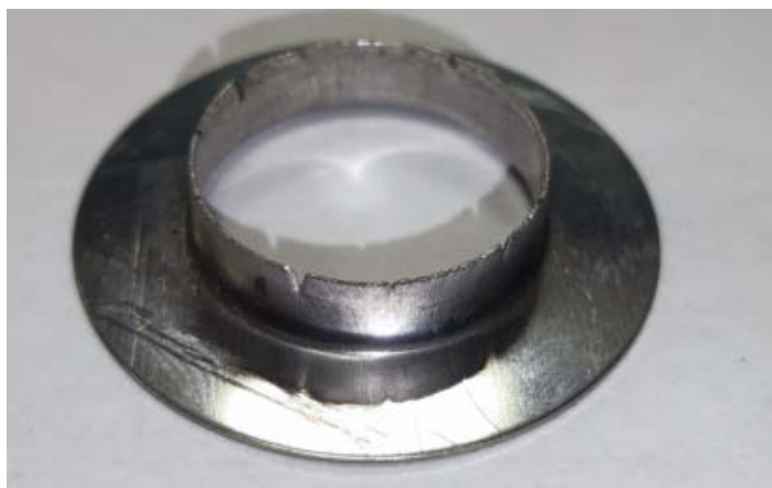
Рисунок 3.11 – Внешний вид отсекаеля с поверхностными дефектами
