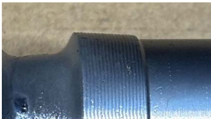
Рисунок 4.4 – Внешний вид конусного участка пальца шарового после токарной обработки контура и нанесения покрытия
