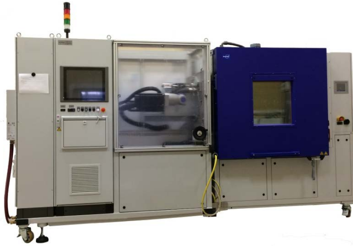
Рисунок 4.8 – Стенд для климатических испытаний шаровых шарниров шасси
