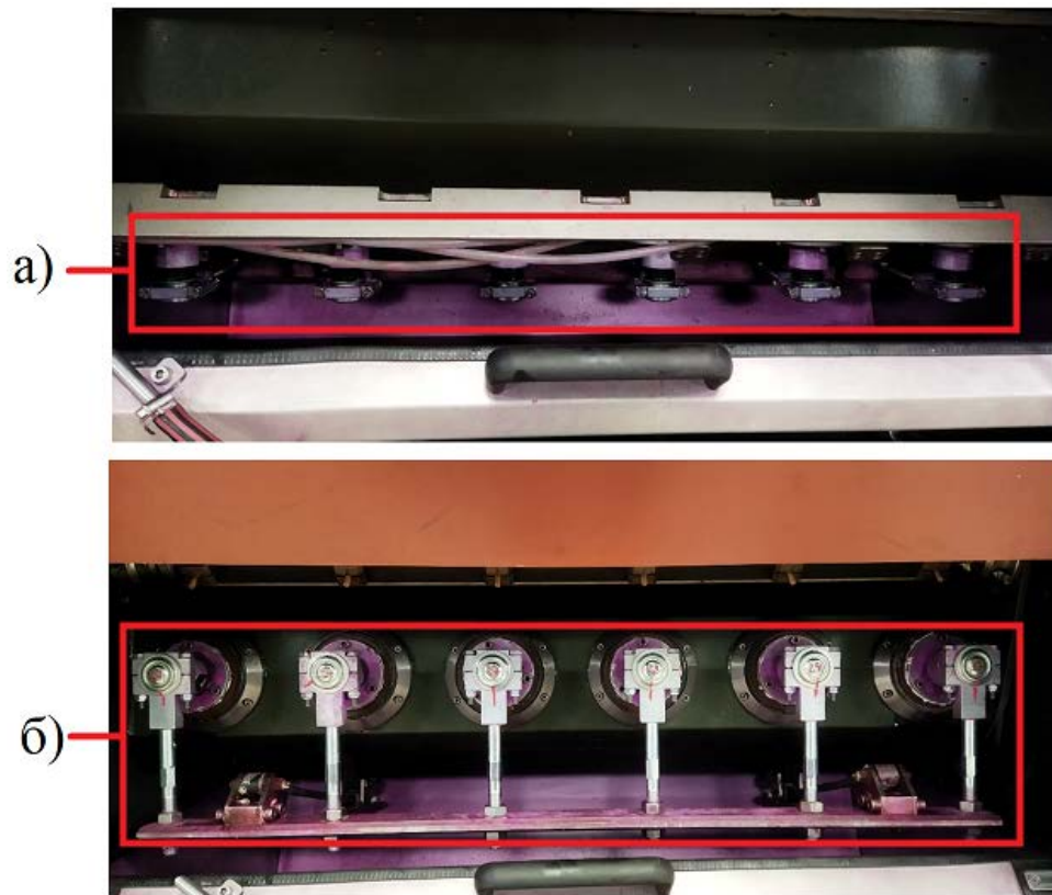
Рисунок 4.9 – Шаровые шарниры передней подвески автомобиля LADA Largus, установленные в испытательный стенд: а – рабочее положение образцов в камере; б – внешний вид оснастки для осуществления движений
