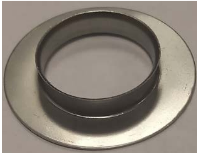
Рисунок 3.18 – Внешний вид отсека еля, изготовленного по модернизированной схеме переходов и с раскаткой бурта
