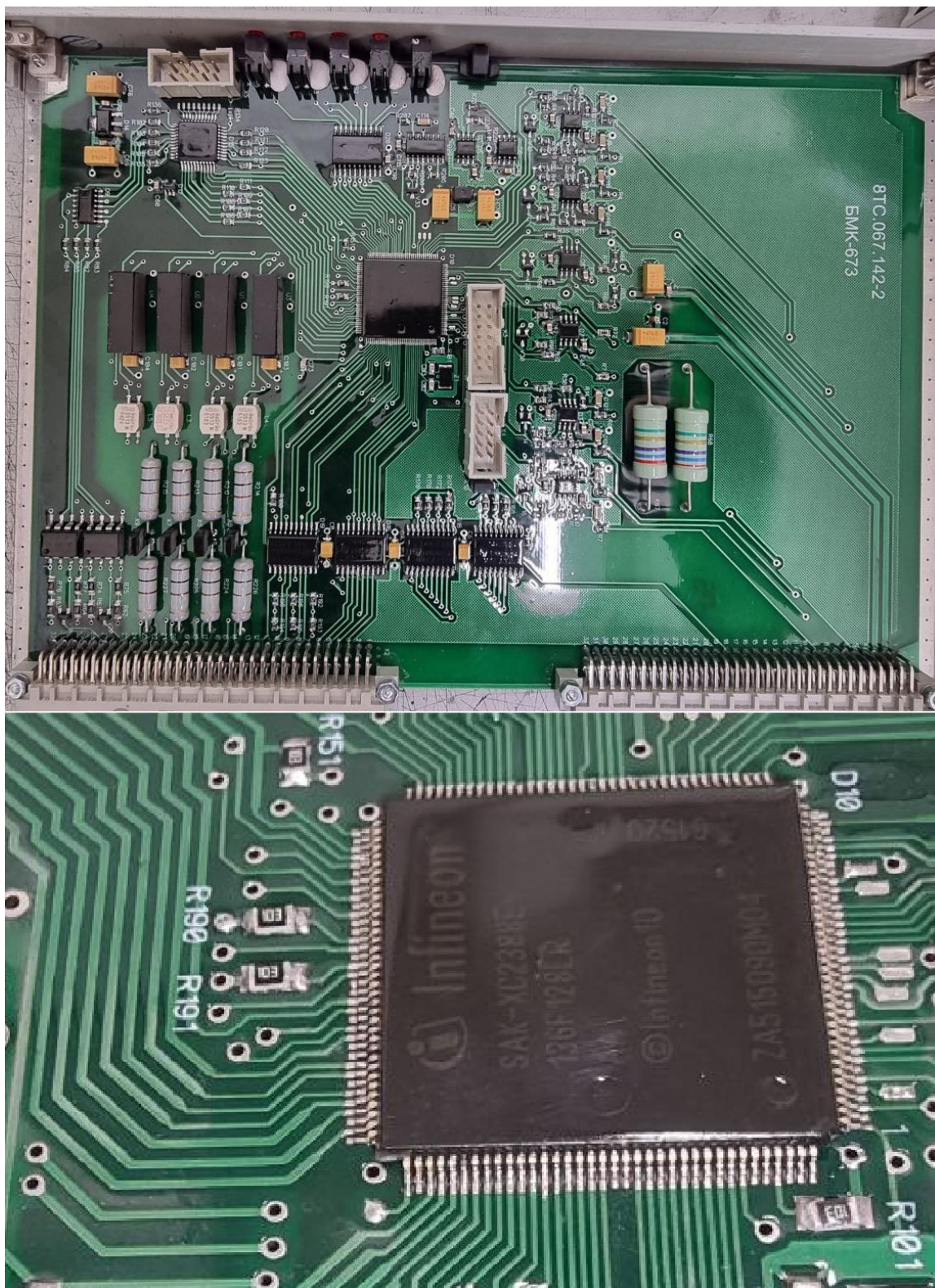
Рисунок 4.15 – Плата контроллера САР инвертера НПМ2М на локомотиве с микропроцессором Infineon SAK-XC2768X-136F128LR
