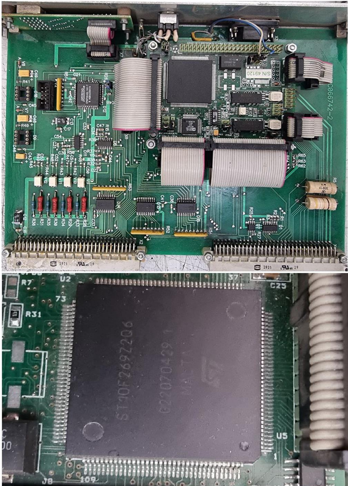
Рисунок 4.14 – Плата контроллера САР инвертера НПМ2 на локомотиве с микропроцессором STM ST10F269Z2Q6
