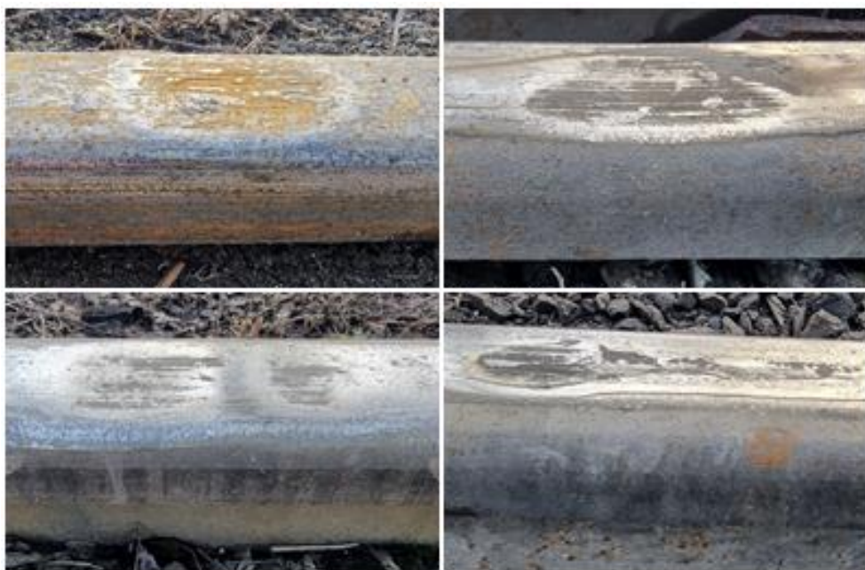
Рисунок 4.11 – Износ (истирание, проплавление) головок рельсов при вследствие разносного боксования локомотивов на тракционных путях депо
