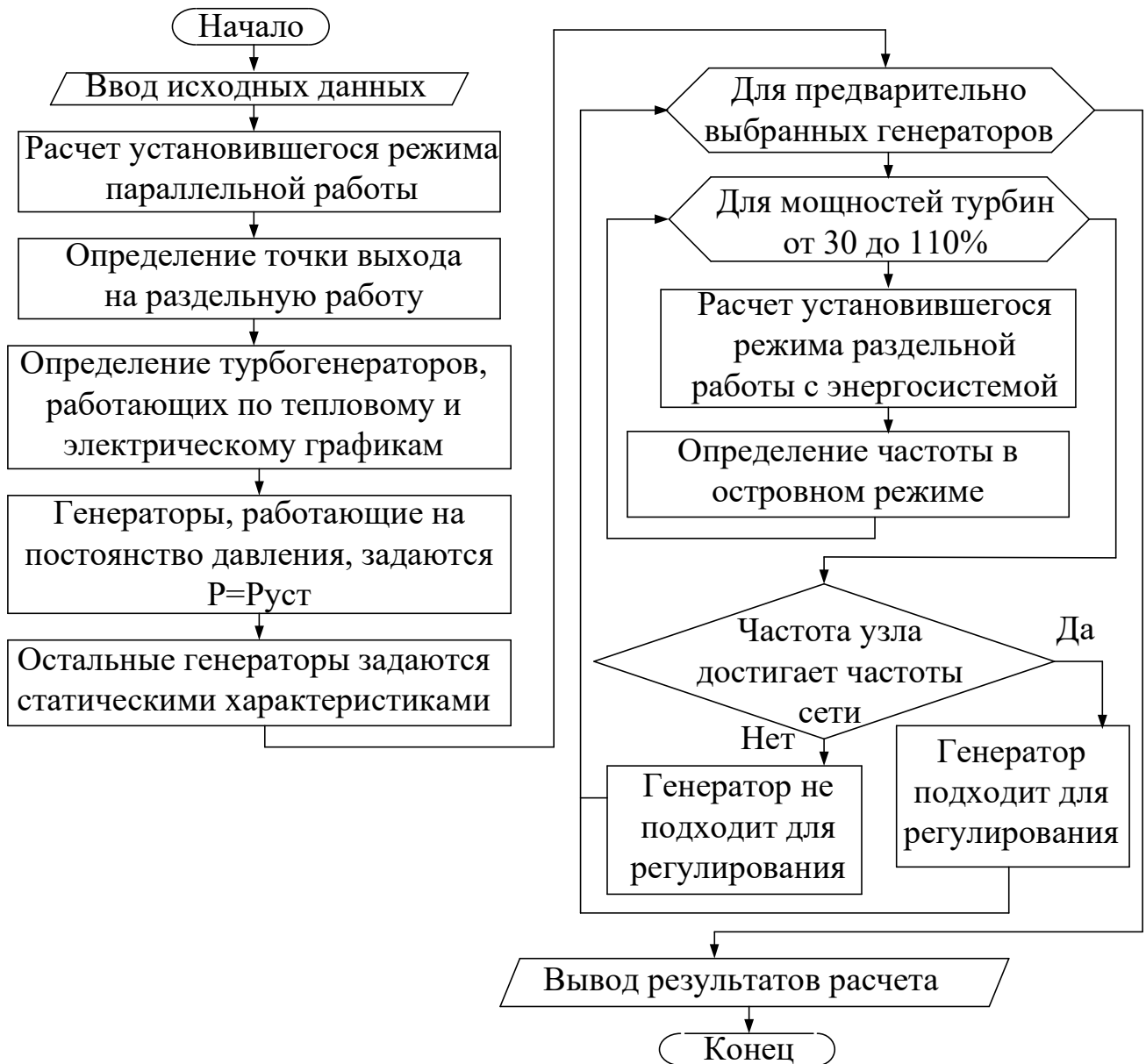
Рисунок 5.15 - Выбор генератора для ресинхронизации
