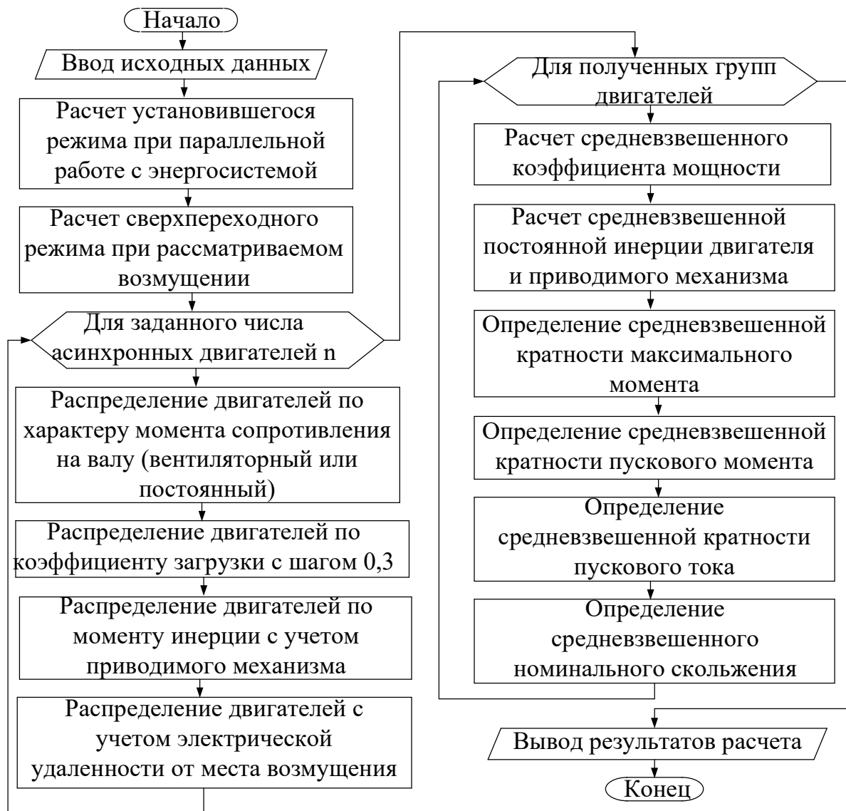
Рисунок 4.5 - Порядок определения параметров эквивалентного асинхронного двигателя
