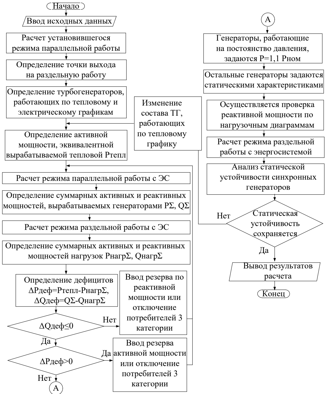
Рисунок 5.14 – Методика распределения функций блоков турбина- генератор
