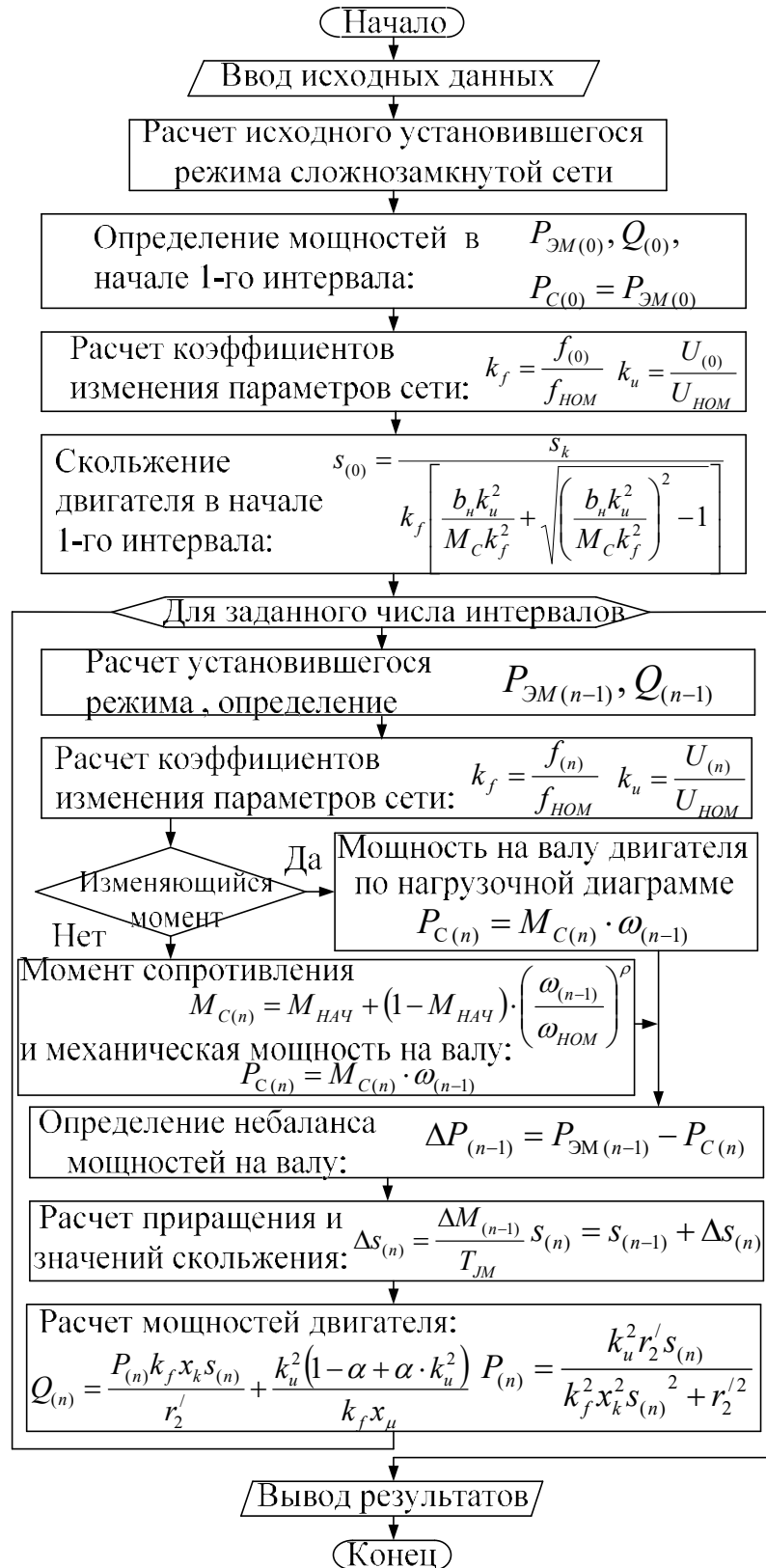
Рисунок 4.4 - Блок-схема расчета параметров режима работы асинхронного двигателя
