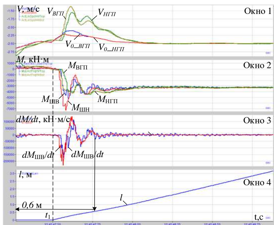
Рисунок 7.15 – Осциллограммы аварийного режима, аналогичные рис. 7.14 (а), и рабочего режима при захвате (б): окно 1 – задания линейных скоростей V_{0\_ВГП} , V_{0\_НГП} и линейные скорости V_{ВГП} , V_{НГП} , м/с; окно 2 – моменты двигателей и шпинделей, кН·м; окно 3 – производные моментов на шпинделях кН·м/с; окно 4 – длина прокатанной части раската, м
