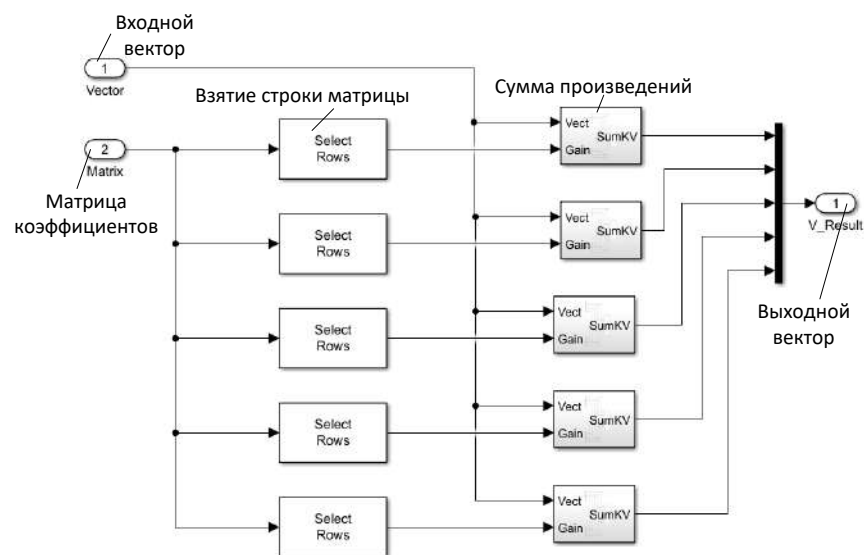
Рисунок П.4.3 – Структура блока умножения матриц
