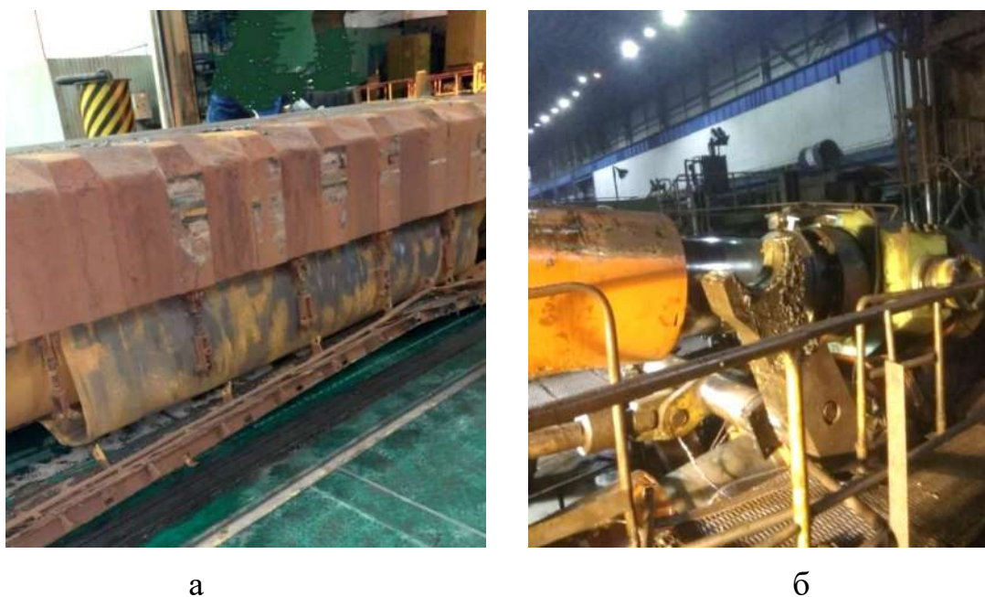
Рисунок 7.13 – Нахлест полосы на валок (а) и разрушение вилки балансировки шпинделя (б)
