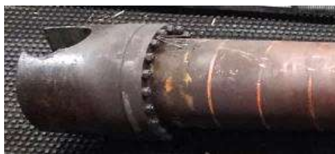
Рисунок 1.12 – Конструкция главной линии горизонтальной клетки (а) и общий вид шпиндельного соединения (б)
