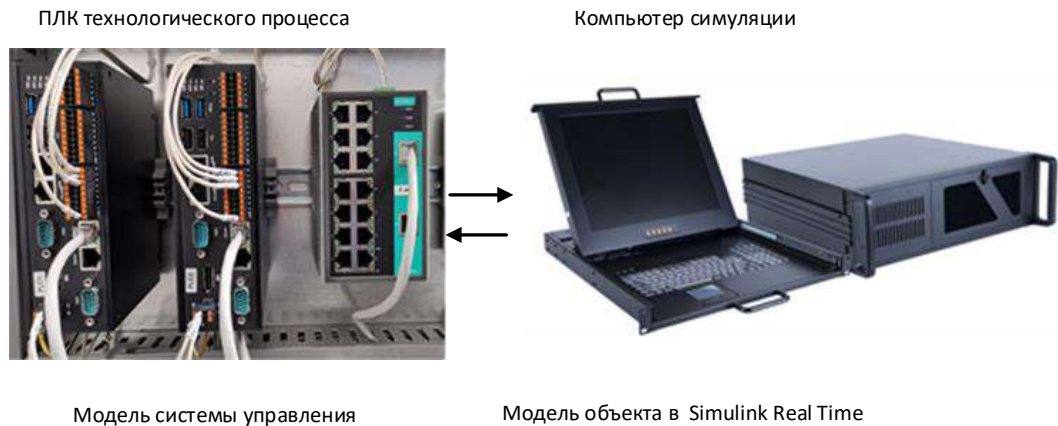
Рисунок 2.5 – Реализация цифрового двойника в Matlab Simulink Desktop Real Time (а) и в лабораторных условиях (б)
