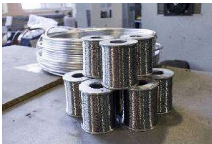
Рисунок 7.13 – Опытные партии непрерывнолитой заготовки из ЭМК диаметром 18 мм ( a ) и проволоки диаметром 0,5 мм ( б ) из сплава 01417
