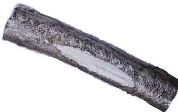
Рисунок 2.17 – Вид круглой заготовки после деформации в прямоугольном ящичном калибре установки СПП и остановки процесса
