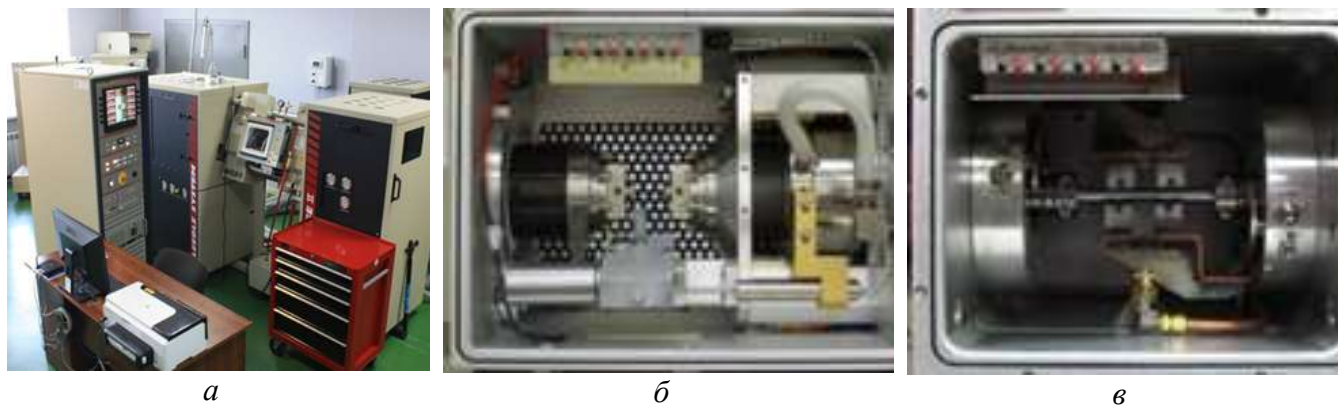
Рисунок 6.2 – Общий вид комплекса Gleeble 3800 (а) и рабочие камеры модулей HydraWedge (б) и Torsion (в)
