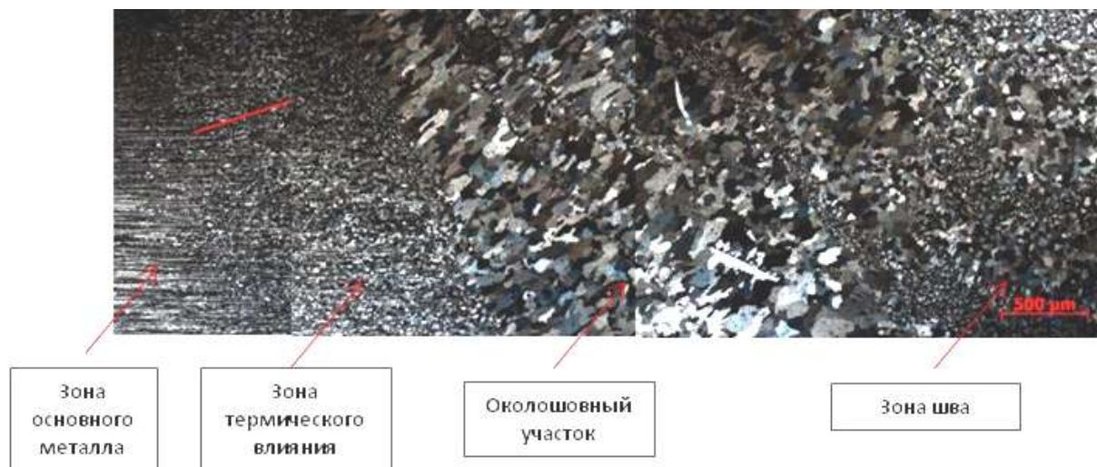
Рисунок 6.21 – Характерные зоны сварных соединений на микроструктуре образцов, \times 50
