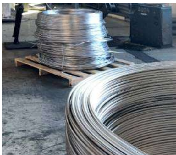
Рисунок 7.13 – Опытные партии непрерывнолитой заготовки из ЭМК диаметром 18 мм ( a ) и проволоки диаметром 0,5 мм ( б ) из сплава 01417
