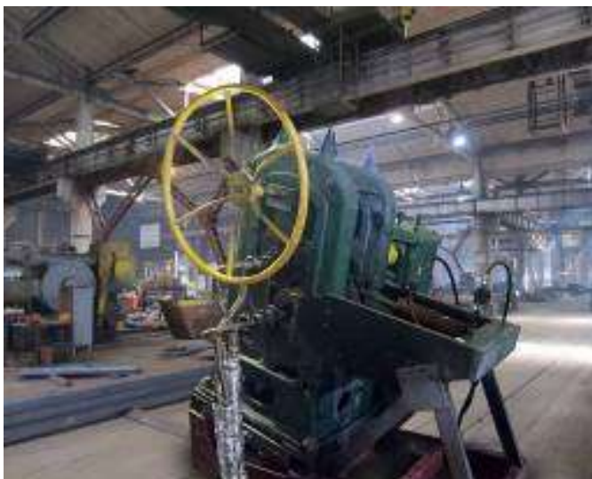
Рисунок 7.10 – Установка промышленного непрерывного прессования, совмещающая прокатку и прессование (модель СПП-400)
