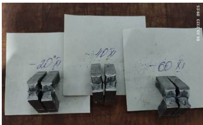
Рисунок 6.10 – Общий вид образцов после испытаний на ударную вязкость
