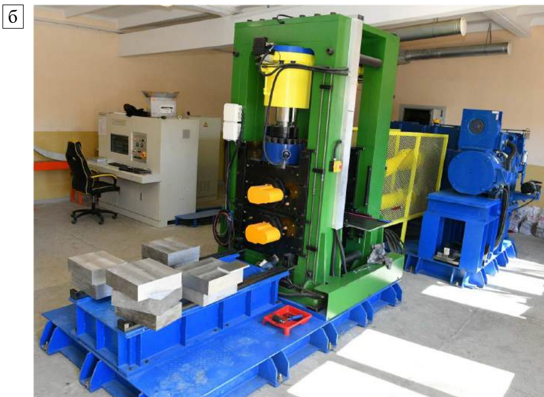
Рисунок 3.1 – Габаритные размеры (а) и общий вид (б) прокатного стана лаборатории «Механика градиентных наноматериалов им. А.П. Жилеева»
