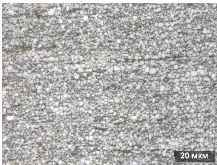
Рисунок 5.31 – Оптическое изображение микроструктуры (0,09C-1,6Mn) после листовой прокатки со скоростной асимметрией ( \frac{v_1}{v_2} = 1,5 ) с охлаждением с охлаждением водой
