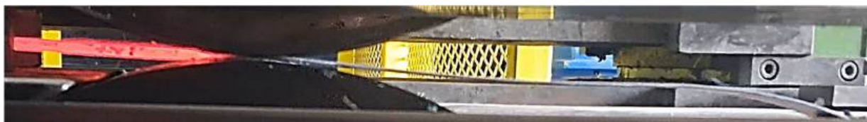
Рисунок 5.43 – Фото деформируемого листа при прокатке со скоростной асимметрией с понижением температуры металла в очаге деформации \Delta T_\epsilon
