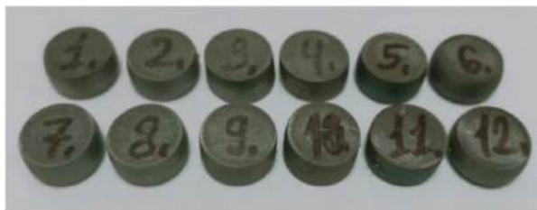
Рисунок 2.4 – Образцы после испытаний на одноосное сжатие
