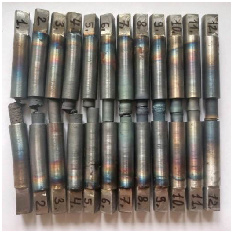
Рисунок 2.8 – Образцы после испытаний на горячее кручение
