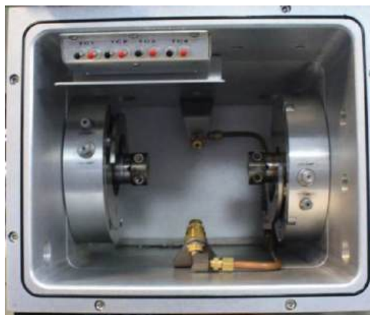
Рисунок 2.5 – Рабочая камера модуля Torsion симулятора термомеханических процессов Gleeble 3800
