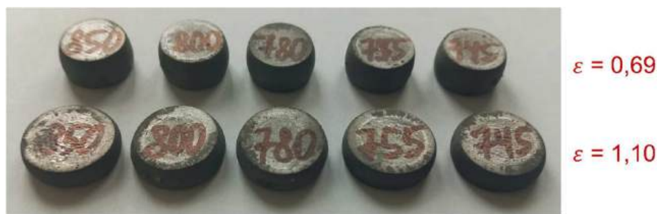
Рисунок 5.17 – Фото образцов после испытаний на сжатие на Gleeble (предварительная логарифмическая деформация \varepsilon = 0,69 и \varepsilon = 1,10 при температурах 850, 800, 780, 755, 745 °C)
