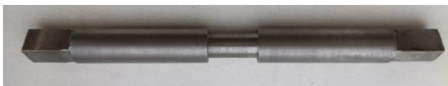
Рисунок 2.7 – Общий вид образца для испытаний на горячее кручение
