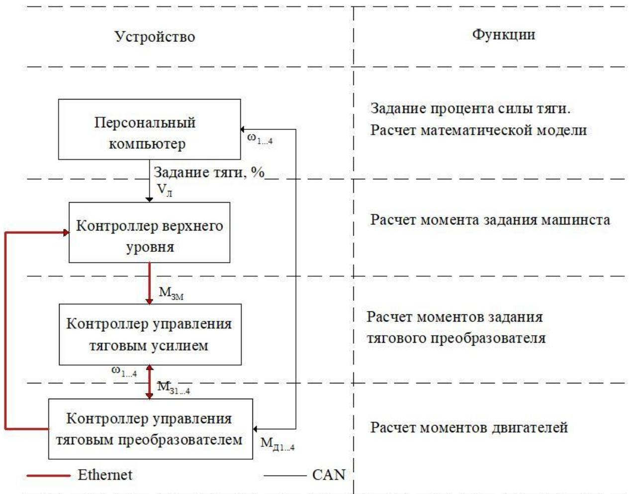
Рисунок 5.3 – Функциональная схема стенда полунатурного моделирования
