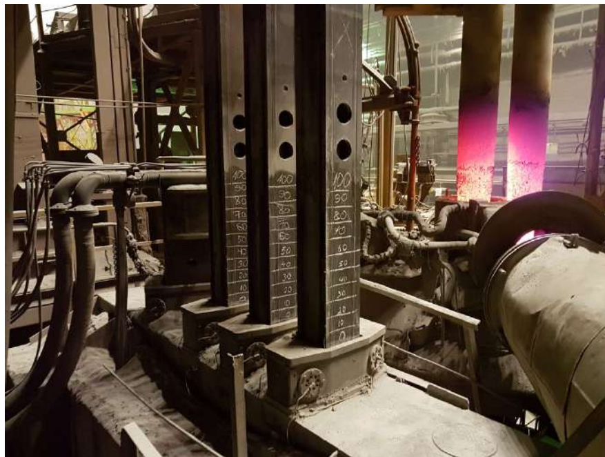
Рис. 2.10 - Искусственная разметка, нанесенная на колонны консолей электродов УКП №2 120 т. ПАО «Северсталь», используемая для снятия регулировочных характеристик гидроприводов при отсутствии датчиков положения
