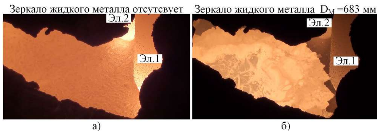
Рис. 1.4. - Возмущения на поверхности жидкого металла, создаваемые работой продувочных блоков: где Эл.1 и Эл.2 – графитированные электроды У КП
