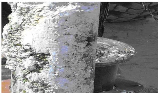
Рисунок 4.5 – Отложения кольматантов на поверхности оборудования откачной скважины
