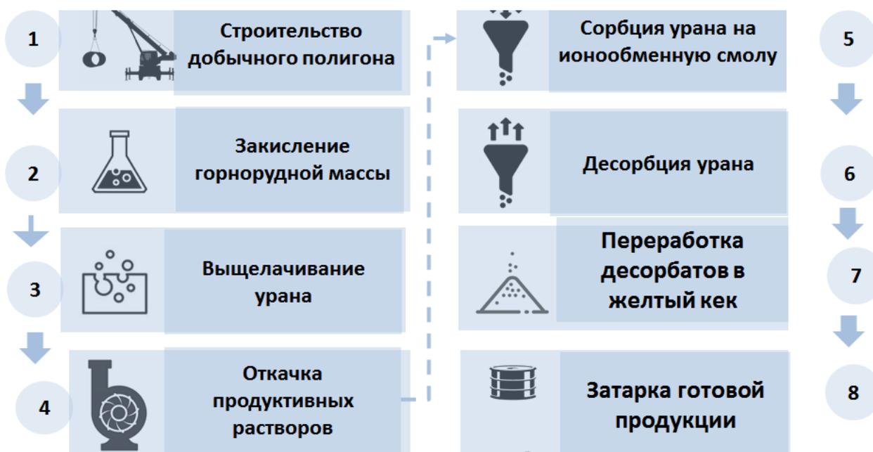
Рисунок 1.1 – Схема технологических операций производства готовой продукции предприятия СПВ
