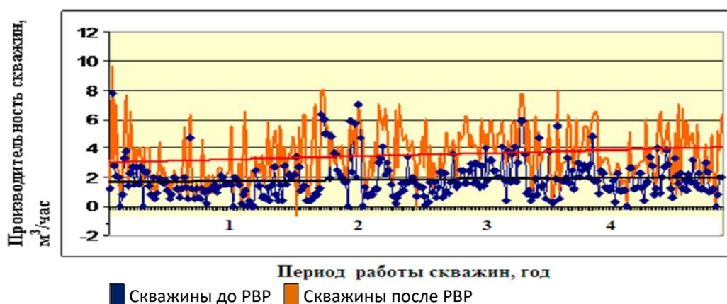
Рисунок 4.19 – Зависимость изменения производительности откачных скважин в течение 4 лет: – усредненные значения производительности скважин до обработки; – усредненные значения производительности скважин после обработки
