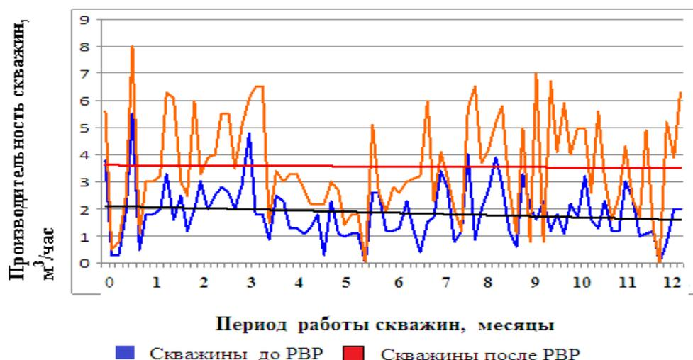
Рисунок 4.23 – Изменение производительности откачных скважин в течение 4 года их работы:
