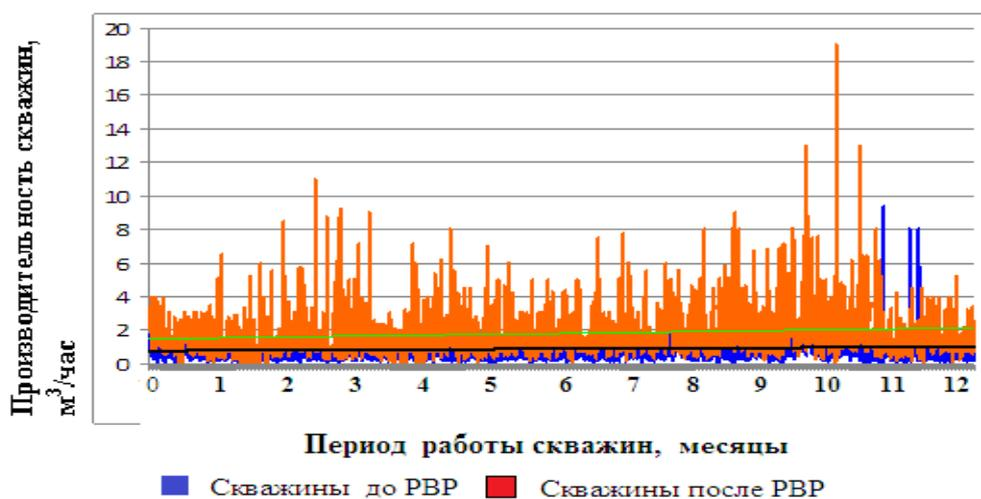
Рисунок 4.18 – Изменение производительности закачных скважин в течение 4 лет (2021 г.) их работы:
