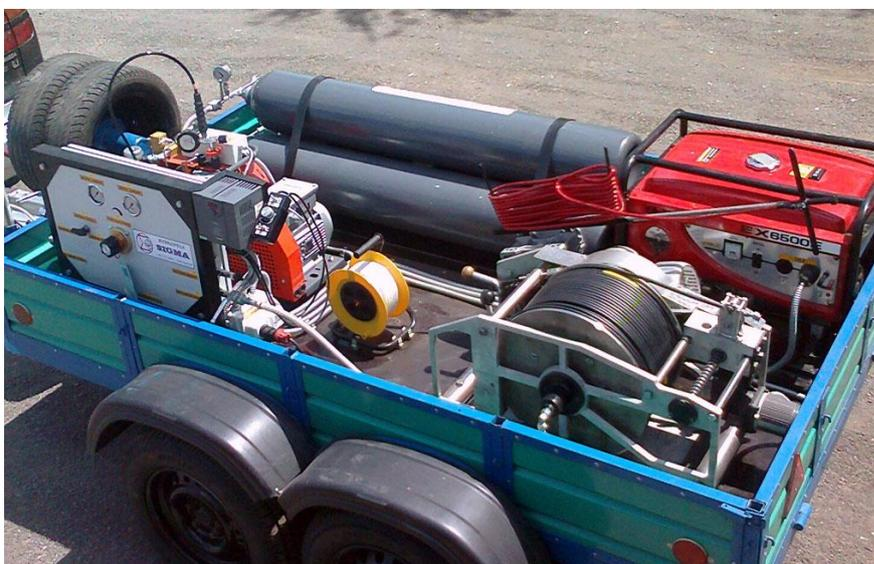
Рисунок 4.9 – Гидропневмоимпульсная установка HYDROPULS
