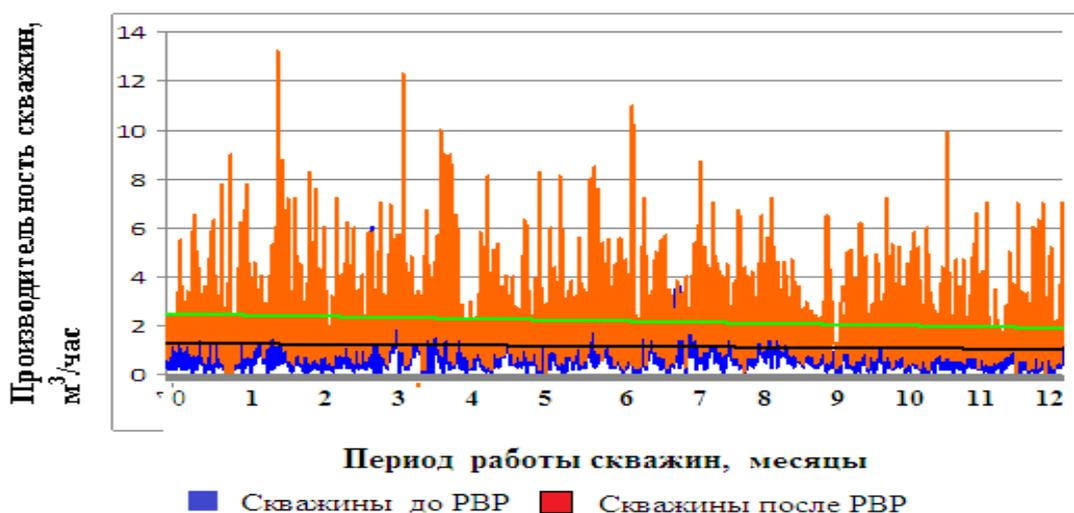
Рисунок 4.17 – Изменение производительности закачных скважин в течение 3 года (2020 г.) их работы:
