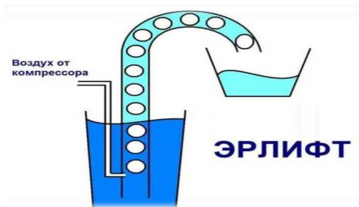
Рисунок 4.3 – Схема эрлифтной прокачки
