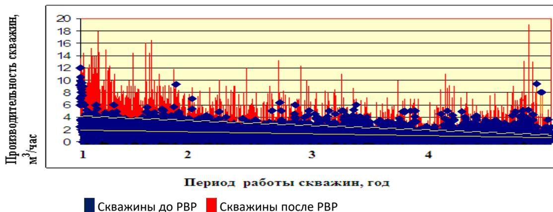
Рисунок 4.13 – Зависимость изменения производительности закачных скважин от срока их службы: ■ – усредненные значения производительности скважин до обработки; ■ – усредненные значения производительности скважин после обработки
