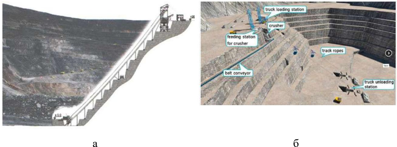
Рисунок 1.17 - Схема скиповой канатно-рельсовой а) и подвесной б) транспортной системы фирмы «ТиссенКрупп»
