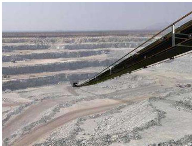
Рисунок 1.21 – Вариант размещения карьерного конвейера без формирования опор на борту карьера [324]
