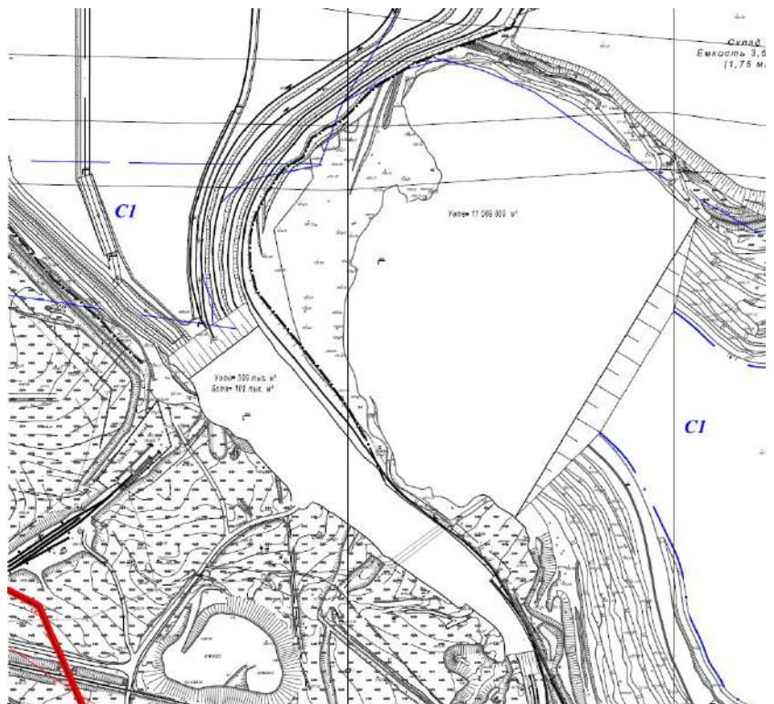
Рисунок 6.3 – Элемент ситуационного плана с размещенными внутренними отвалами в Северо-Западном и Центральном карьерах
