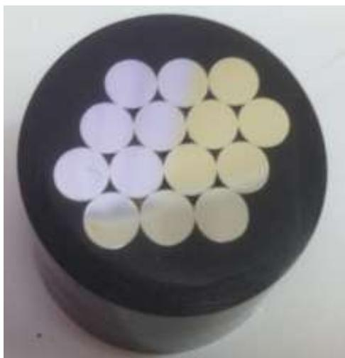
Рисунок 3.11 – Образец, подготовленный к рентгеноструктурному анализу
