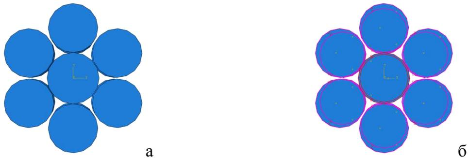
Рисунок 2.30 – Сечение модели (а) каната конструкции 1×7 (1+6) и области применения контактных условий (б)
