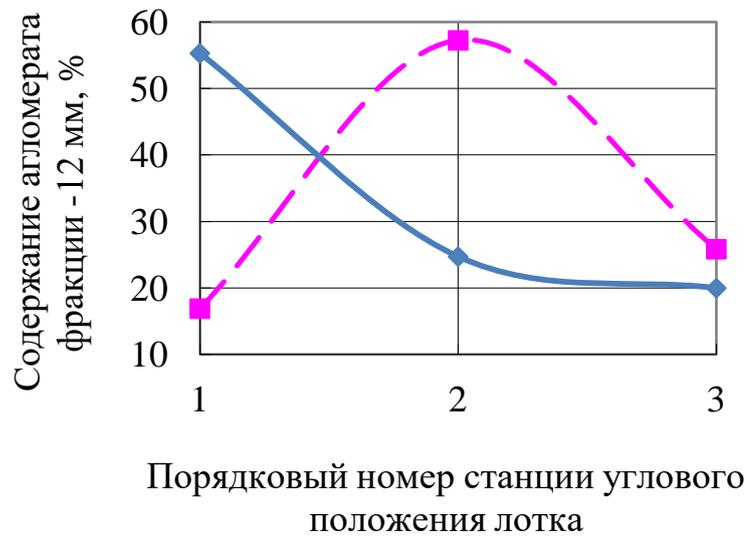
Рисунок 3.3 – Содержание некондиционного агломерата от его расхода, загружаемого на колошник со станций углового положения лотка по ходу его движения при односкиповом заполнении бункера и поступлении агломерата в скип первым ( -■-) и последним ( -◆-)
