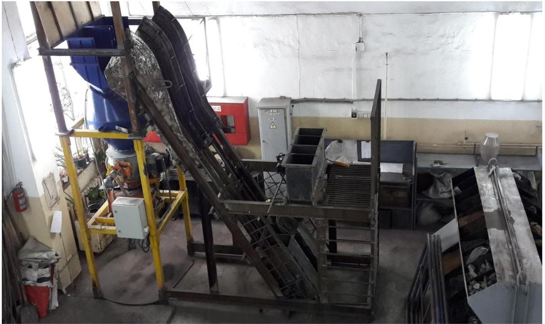
Рисунок 3.2 – Скиповая система загрузки шихтовых материалов в физическую модель бесконусного загрузочного устройства
