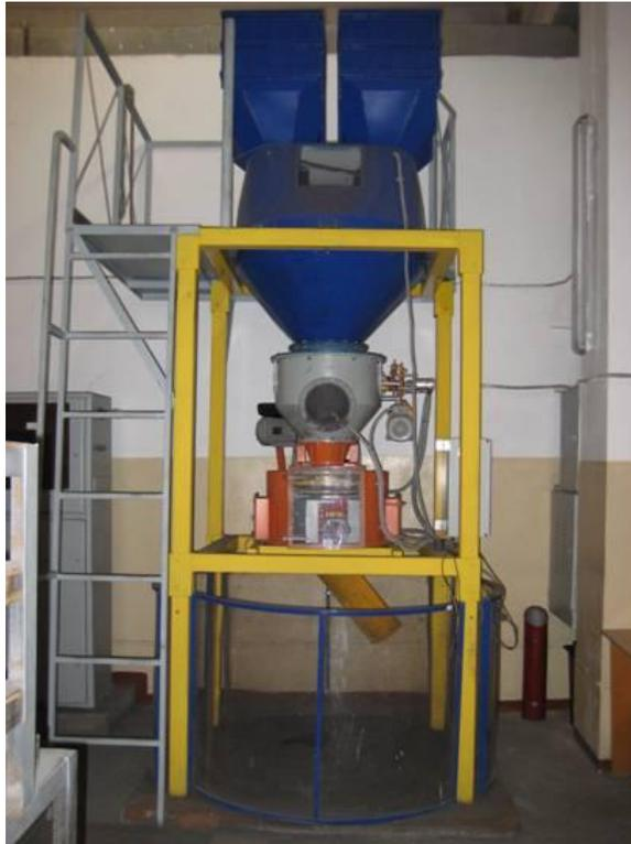
Рисунок 3.1 – Физическая модель однокоткового компактного загрузочного устройства лоткового типа
