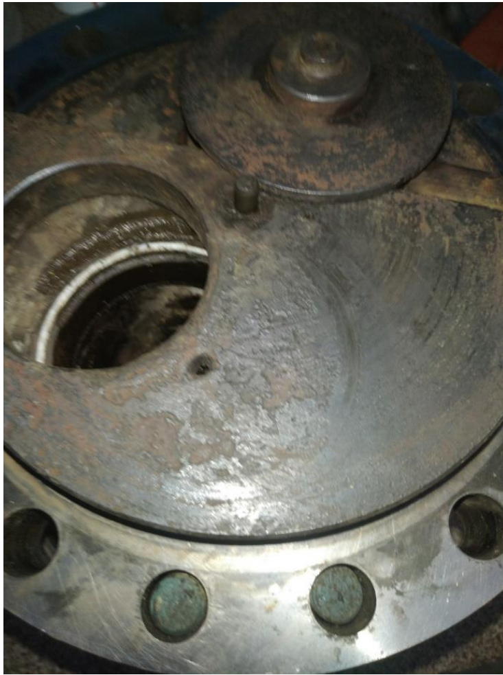
Рисунок 5.1 – Внешний вид дисковой задвижки после эксплуатации на Усть-Тегусском месторождении а) внутренняя поверхность; б) запорный диск; в) наружная поверхность задвижки.
