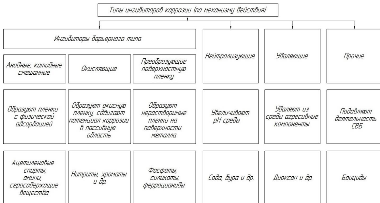
Рисунок 1.1 - Классификация ингибиторов коррозии на основе механизма их действия
