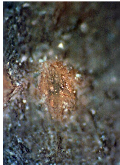
Рисунок 2.10 – Включения тонкодисперсной самородной меди в цементе породы. Прожилок малахита (зеленовато-серое).
