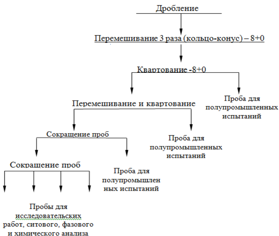
Рисунок 2.5 - Схема подготовки пробы к технологическим исследованиям
