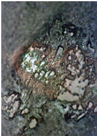
Рисунок 2.9 – Прожилок малахита (зеленовато-серое). Включения тонкодисперсной самородной меди.
