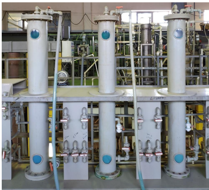
Рисунок 4.3 – Сорбционная установка для полупромышленных испытаний
