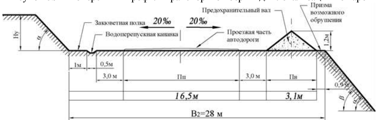
Рисунок 6.10 – Поперечный профиль капитальной траншеи при доработке запасов
