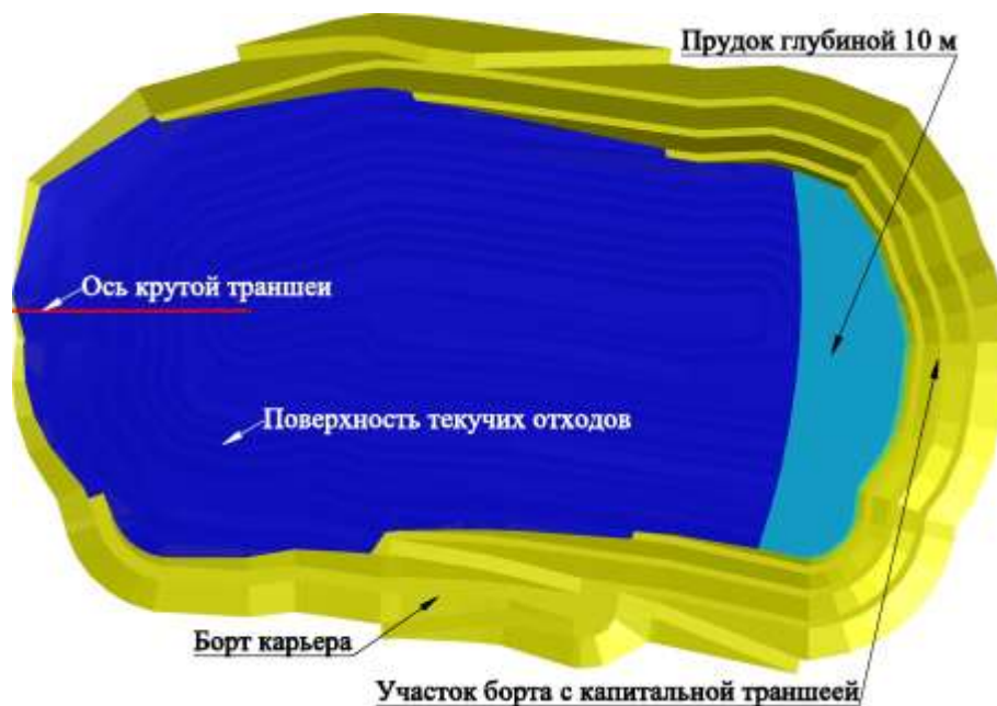
Рисунок 3.5 – Схема оптимального заложения крутой и капитальной траншей для карьеров вытянутой в плане формы
