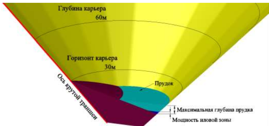
Рисунок 3.11 – Фрагмент плана (а) и разреза (б) модели выработанного пространства карьера при размещении текучих отходов
