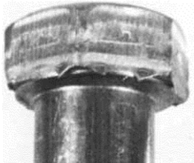
Рисунок 3.2 - Фотография головки болта М12 из нержавеющей стали 12Х18Н10Т после односторонней обрезки на шестигранник
