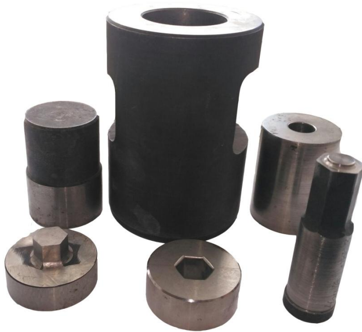
Рисунок 4.4 - Инструмент для экспериментов по формированию шестигранных головок болтов из нержавеющей стали
