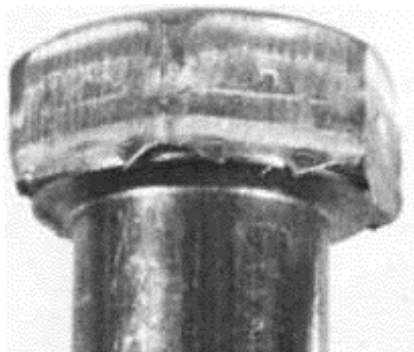
Рисунок 4.15 - Головка болта из стали I2X18H10T после односторонней обрезки на шестигранник
