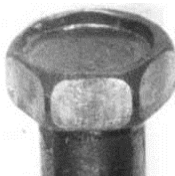
Рисунок 3.11- Шестигранная головка болта, сформированная безоблойной штамповкой с выдавливанием лунки
