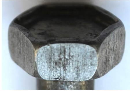
Рисунок 4.23 - Головка болта, сформированная из отожженной заготовки
