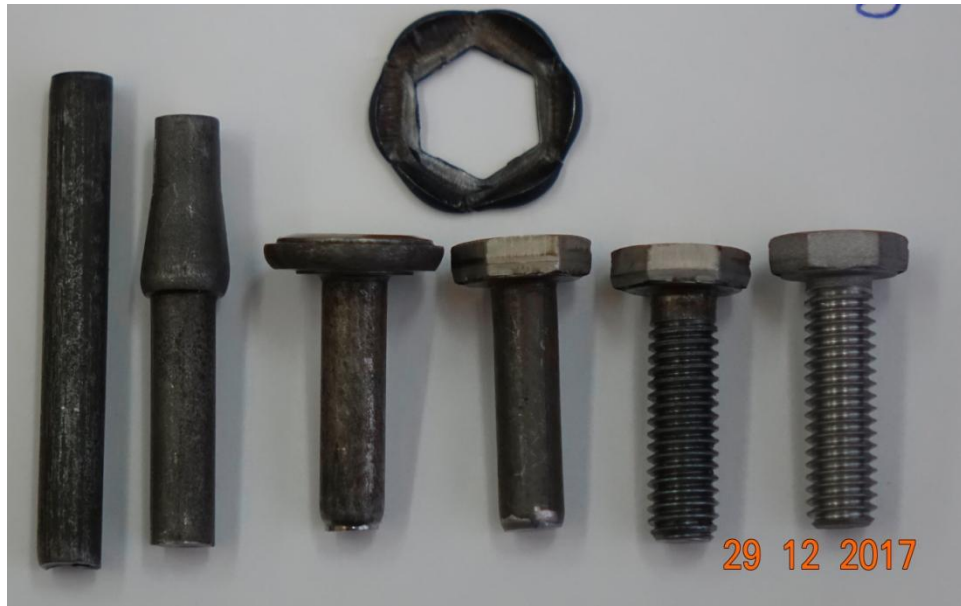
Рисунок 4.28 – Фотография заготовок, изготовленных на автомате 5/16-4ВМ, на отдельных переходах штамповки и готовый винт
