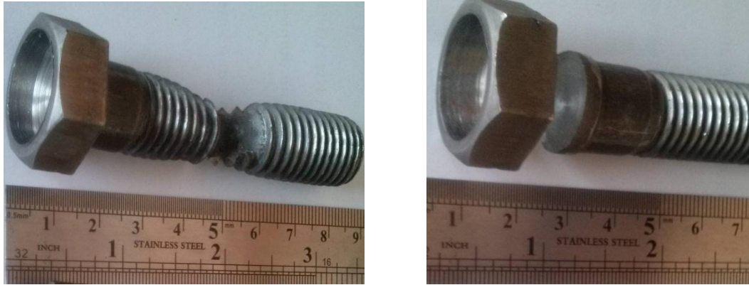
Рисунок 3.20 - Фотографии разрушившихся болтов с торцевой лункой: а –разрушение по резьбе ( h = 5,42 мм); б – разрушение по головке ( h = 7,24 мм)
