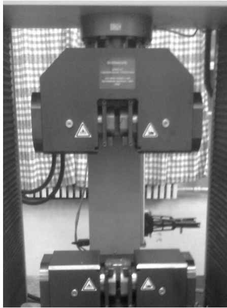
Рисунок 2.2 - Фотография блока крепления образцов универсальной разрывной машины «LFM»
