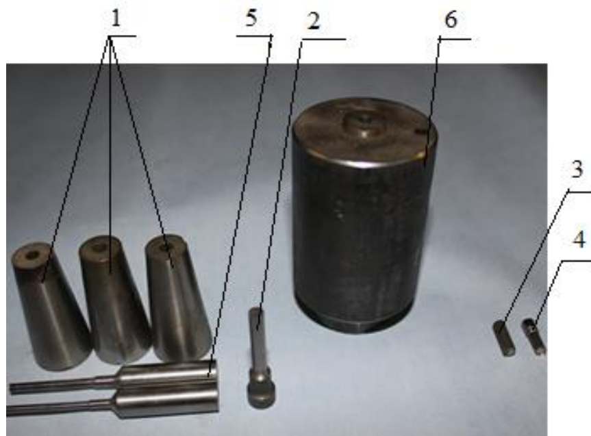
Рисунок 2.7 - Инструментальная оснастка: 1 – матрица; 2 – пуансон; 3 – исходная заготовка; 4 – заготовка после деформации; 5 - выталкиватель; 6 – корпус для центрирования инструмента
