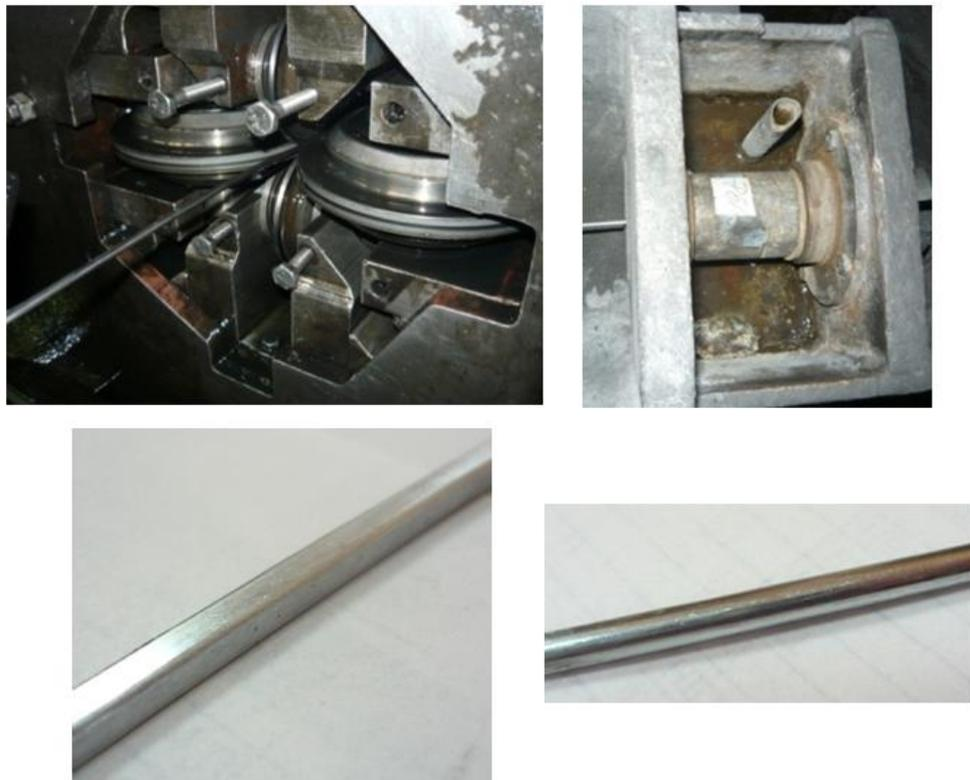
Рисунок 4.4 – Четырехроликовая волока (а) для волочения промежуточной проволоки квадратного сечения (б) и монолитная волока (в) для волочения готовой проволоки (г)
