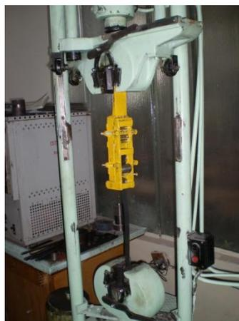
Рисунок 4.3 - Фото модели установки с протянутой полосой в конечном положении
