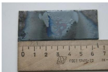
Рисунок 3.29 - След от струи жидкости через форсунку диаметром 2 мм
