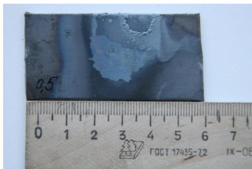
Рисунок 3.26 - След от струи жидкости через форсунку диаметром 0,5 мм
