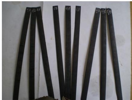
Рисунок 4.5 - Вид пластин перед заправкой в модель изгибо-растяжного окалиноломателя
