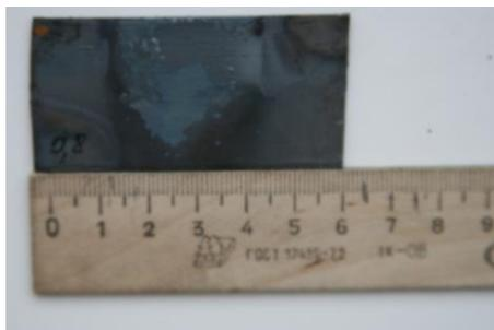
Рисунок 3.27 - След от струи жидкости через форсунку диаметром 0,8 мм
