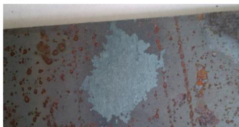
Рисунок 3.28 - След от струи жидкости через форсунку диаметром 1,5 мм
