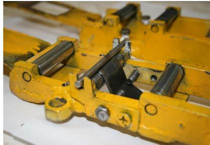
Рисунок 4.8 - Общий вид устройства моделирующего изгибо-растяжной окалиноломатель с установленным роликом
