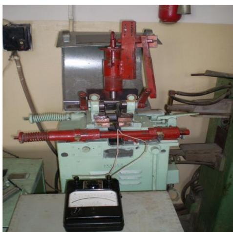
Рисунок 3.20 - Лабораторная установка для исследования процесса гидромеханического удаления окалины.
