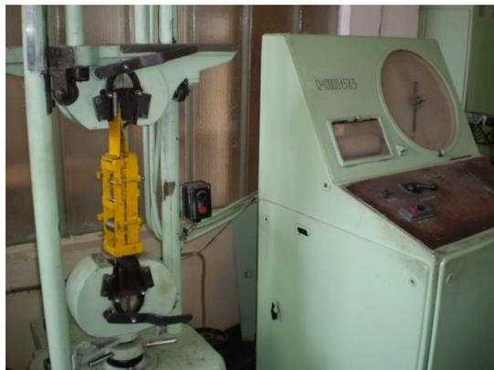
Рисунок 4.1 - Установка моделирования упруго-пластического изгиба в сборе на разрывной машине ММ-10
