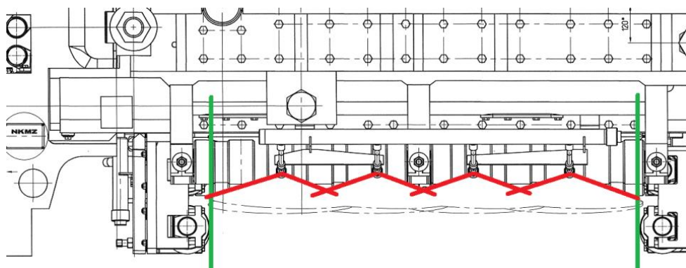
Рис. 3. Схема форсуночного охлаждения под кристаллизатором МНЛЗ №2, 3 для сляба сечением 250×1340 мм
