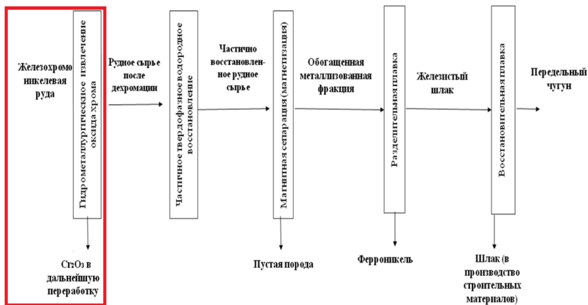
Рис. 1. Предлагаемая модифицированная схема переработки бедных железохромоникелевых руд с предварительным гидрометаллургическим извлечением хрома.
