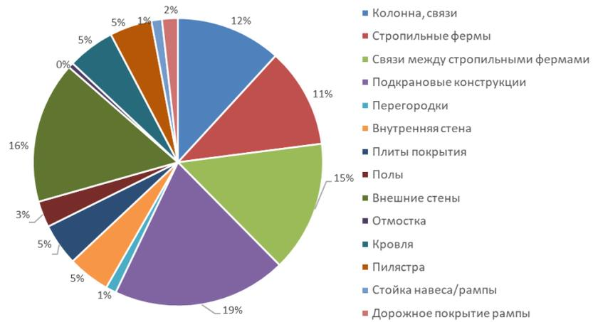
Рис. 3. Классификация дефектов и повреждений здания склада №2 УПП, выявленные в результате ЭПБ в 2024 году (по однотипным группам конструкций)
