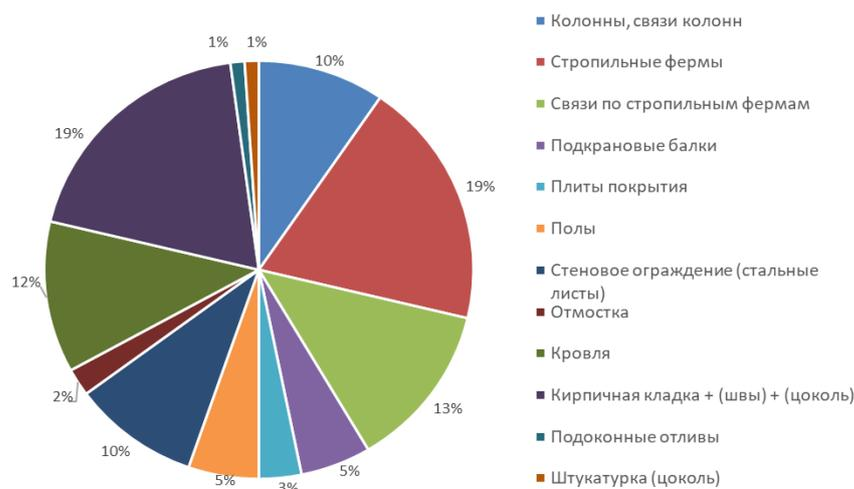
Рис. 2. Классификация дефектов и повреждений здания склада №2 УПП, выявленные в результате ЭПБ в 2020 году (по однотипным группам конструкций)
