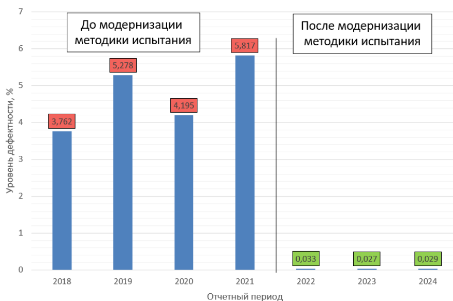
Рис 2. Результаты внедрения модернизированной методики испытания на герметичность
