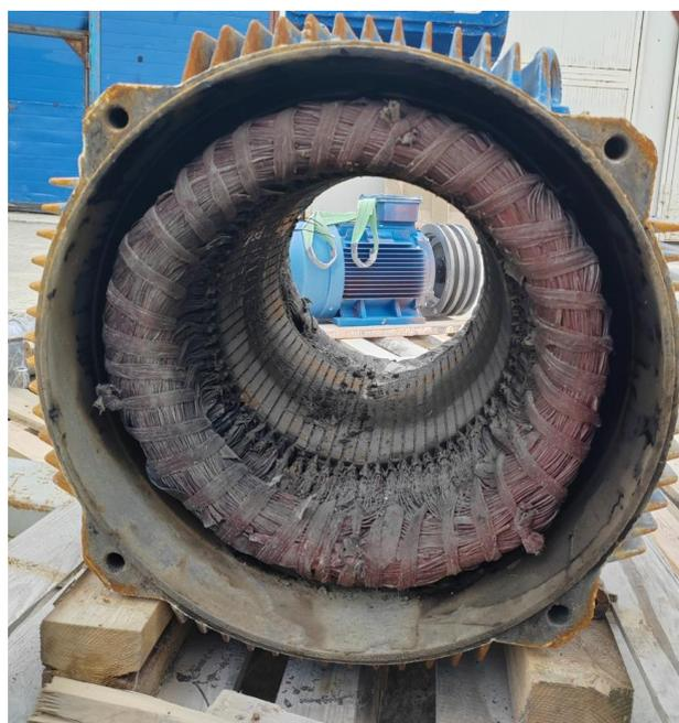
Рис. 1. Состояние статора в результате выхода из строя асинхронного электродвигателя
