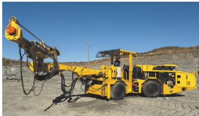
Рис. 2 Буровая проходческая установка DF- B1
