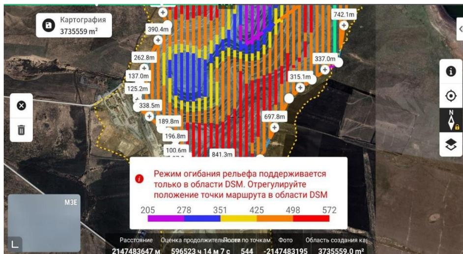
Рис. 3. План полета с учетом огибания рельефа по построенной ранее ЦММ
