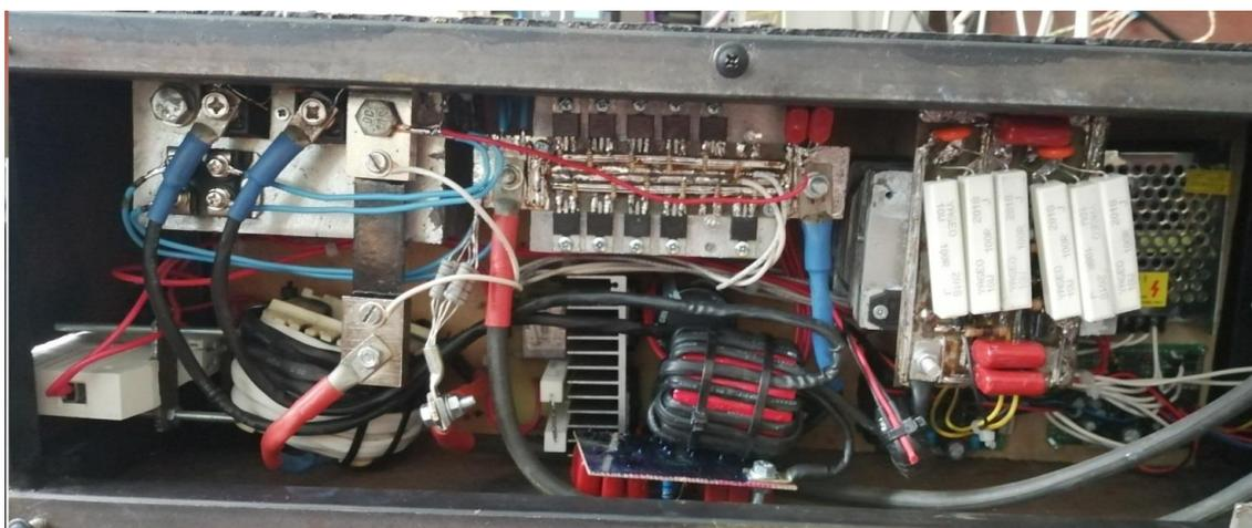
Рис. 5. Источник токовых импульсов в сборе
