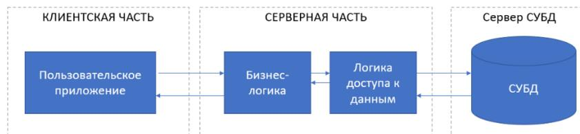
Рис. 2. Трёхуровневая архитектура клиент-сервер
