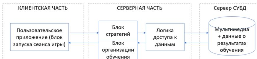
Рис. 3. Трёхуровневая архитектура клиент-сервер КЛКИ
