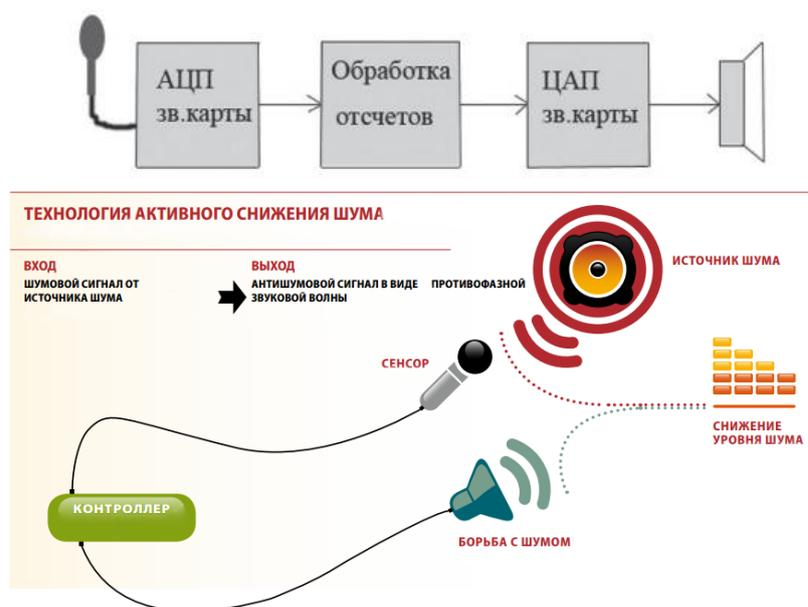
**Рис. 3. Общая схема подавления звука**
