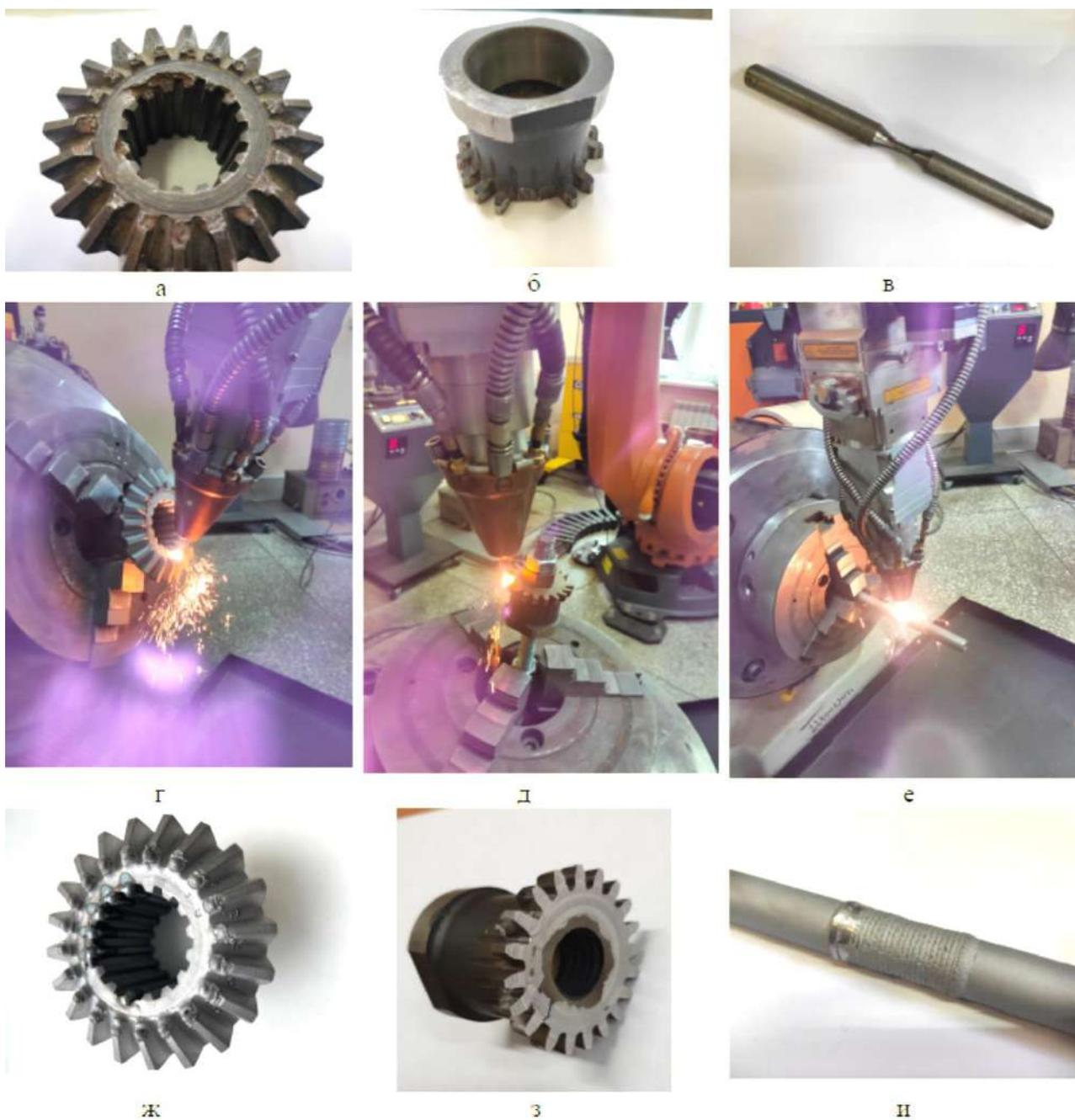
Рисунок 2.4 – Восстановление деталей узлов и агрегатов методом лазерной наплавки порошка TRIP-стали, полученного от иностранного партнера:
