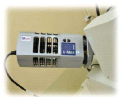
Рисунок 7.5 – Растровый электронный микроскоп JSM-6490LV JEOL с системой микроанализа INCA Energy 450 x-MAX 50 Premium, HKLPremiumEBSDSystemNordlysII 2 SOxfordInstrumentsLtd
