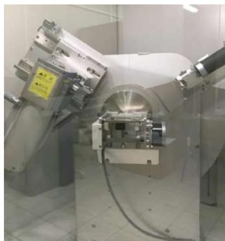
Рисунок 4.8 – Рентгеновский дифрактометр Shimadzu XRD-7000
