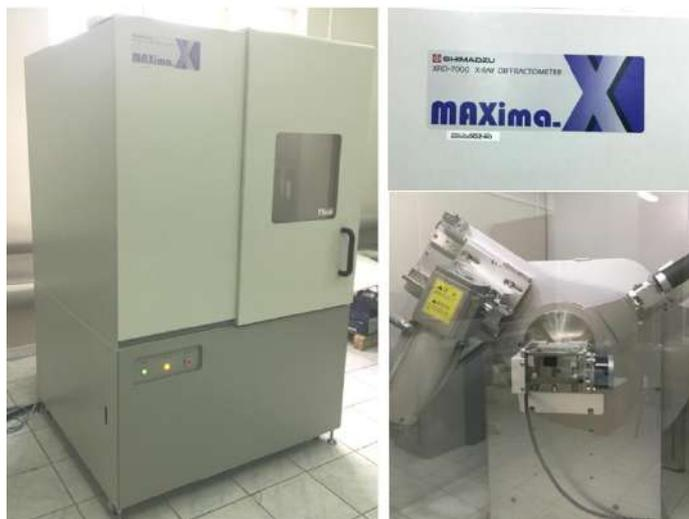
Рисунок 4.7 – Рентгеновский дифрактометр Shimadzu XRD-7000
