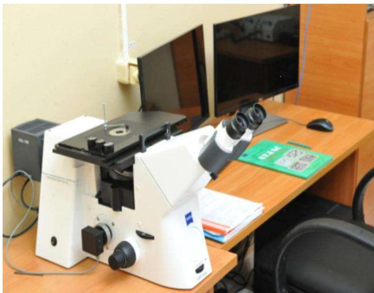
Рисунок 4.4 – Металлографический инвертированный микроскоп
