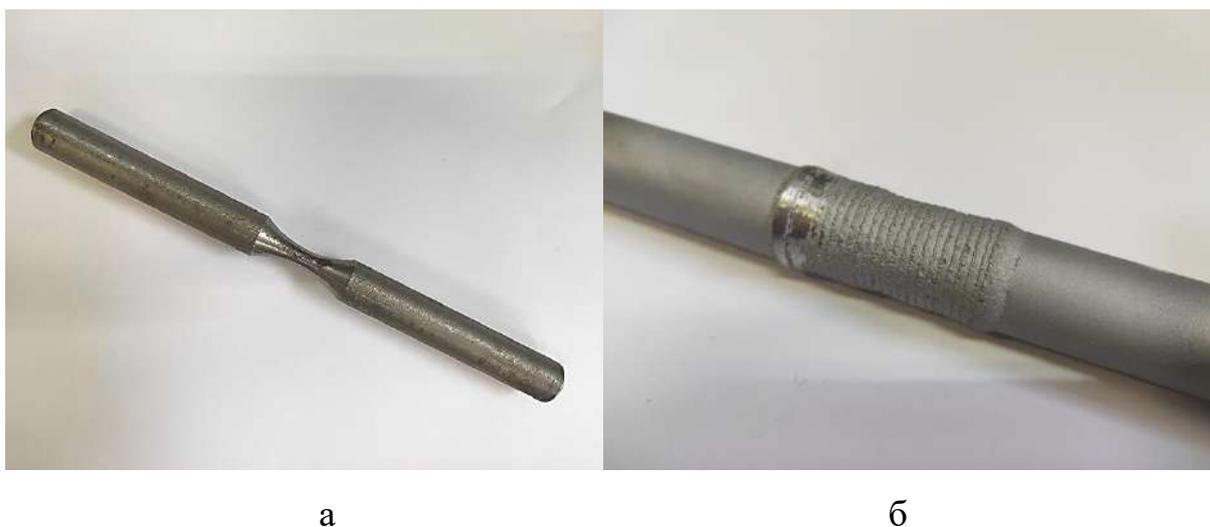
Рисунок 4.1 – Внешний вид исследуемого образца типа вал с проточкой: а - до лазерной наплавки порошка TRIP-стали; б – участок образца после лазерной наплавки порошка TRIP-стали
