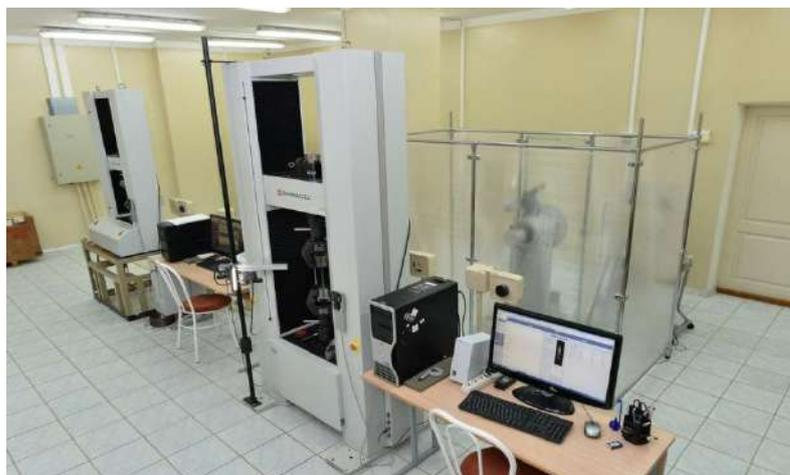
Рисунок 4.11 – Универсальная испытательная машина Shimadzu AG-IC
