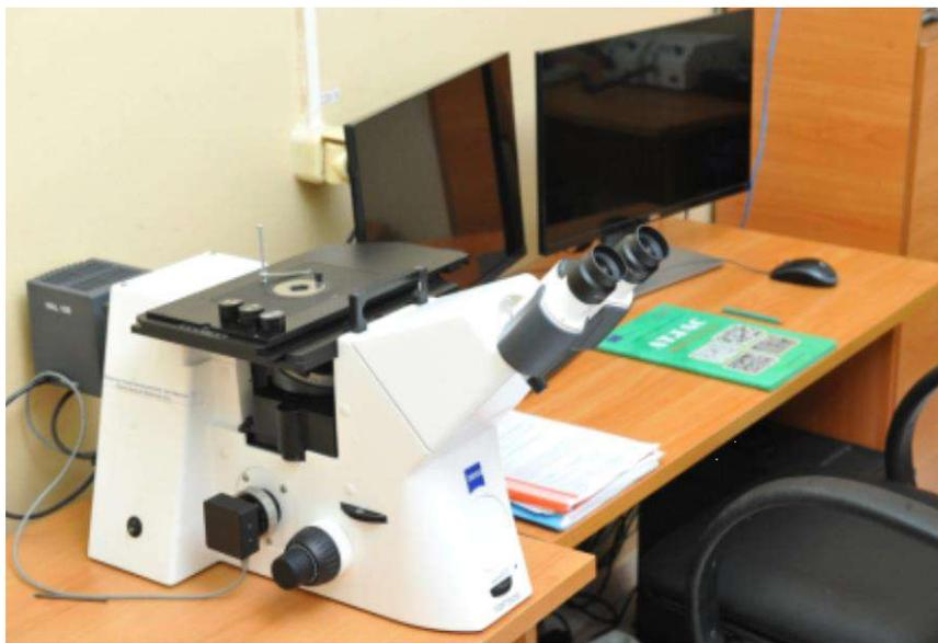
Рисунок 4.4 – Металлографический инвертированный микроскоп ZeissAxioObserver
