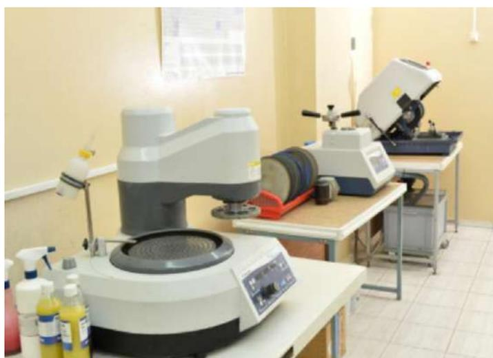
Рисунок 4.3 – Оборудование для пробоподготовки шлифов экспериментального образца
