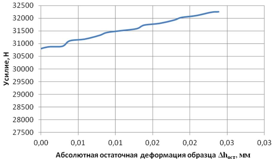
Рисунок 3.4 – Диаграмма испытания для определения условного предела текучести при сжатии
