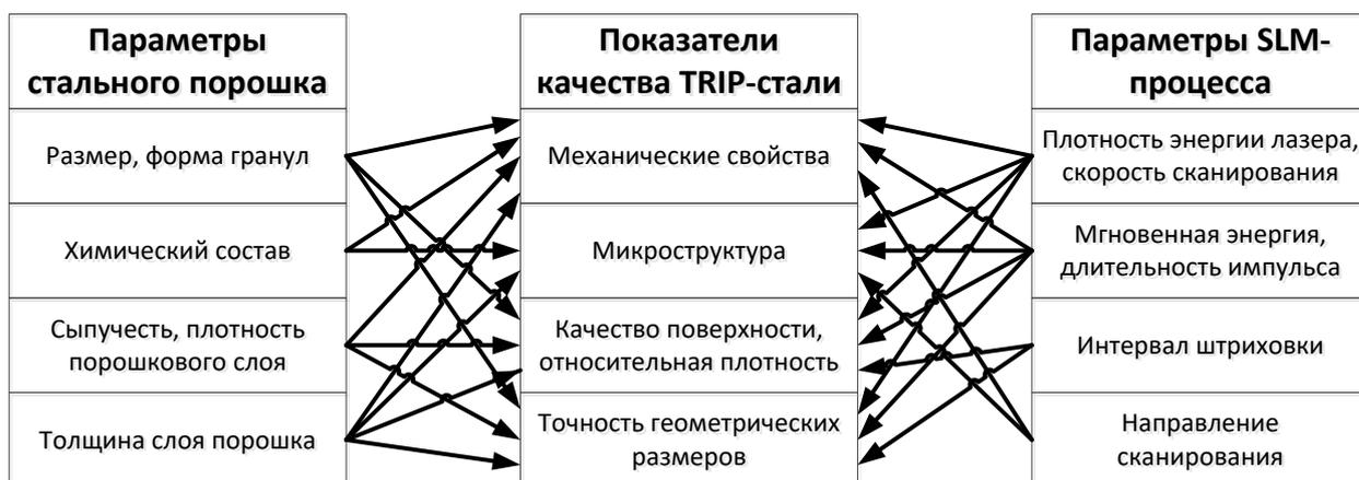
Рисунок 5.9 – Схема взаимосвязи показателей качества TRIP-стали, параметров стального порошка и параметров SLM-процесса
