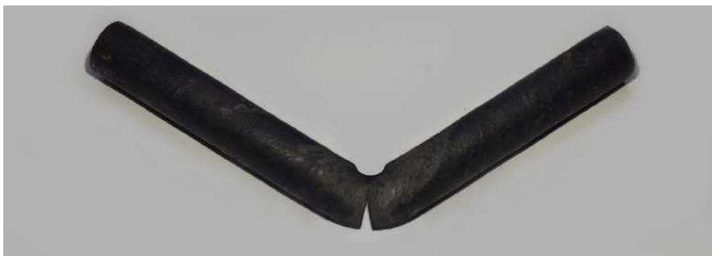
Рисунок 3.8 – Характерный вид образца после испытания на трехточечный изгиб
