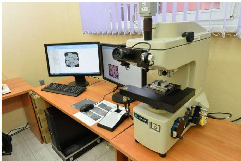
Рисунок 4.9 – Микротвердомер BuehlerMicromet 5103 Buehler
