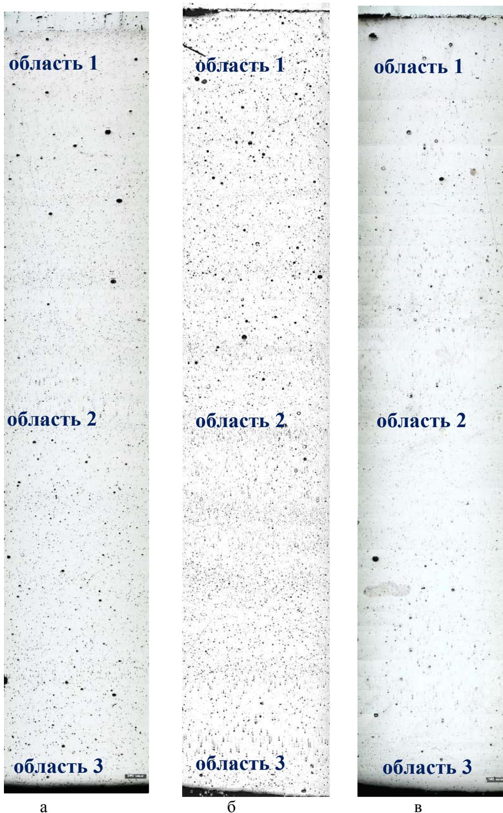
Рисунок 4.29 – Общий вид микроструктуры образцов TRIP-стали, изготовленных методом 3D-печати, в зависимости от энергосиловых параметров обработки в нетравленном виде: а – образец № 1-1; б- образец № 1-2; в- образец № 1-3. Световая микроскопия, х 50 (направление исследования вдоль 3D-печати)
