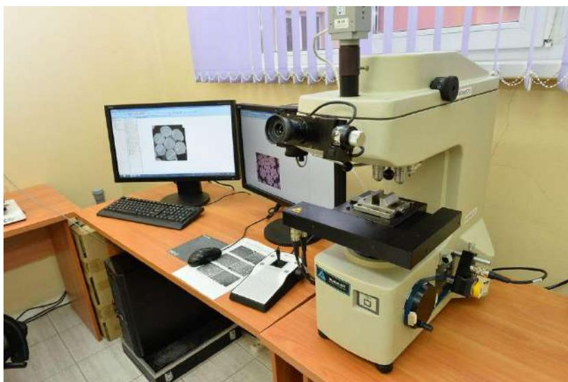
Рисунок 4.10 – Микротвердомер BuehlerMicromet 5103 Buehler
