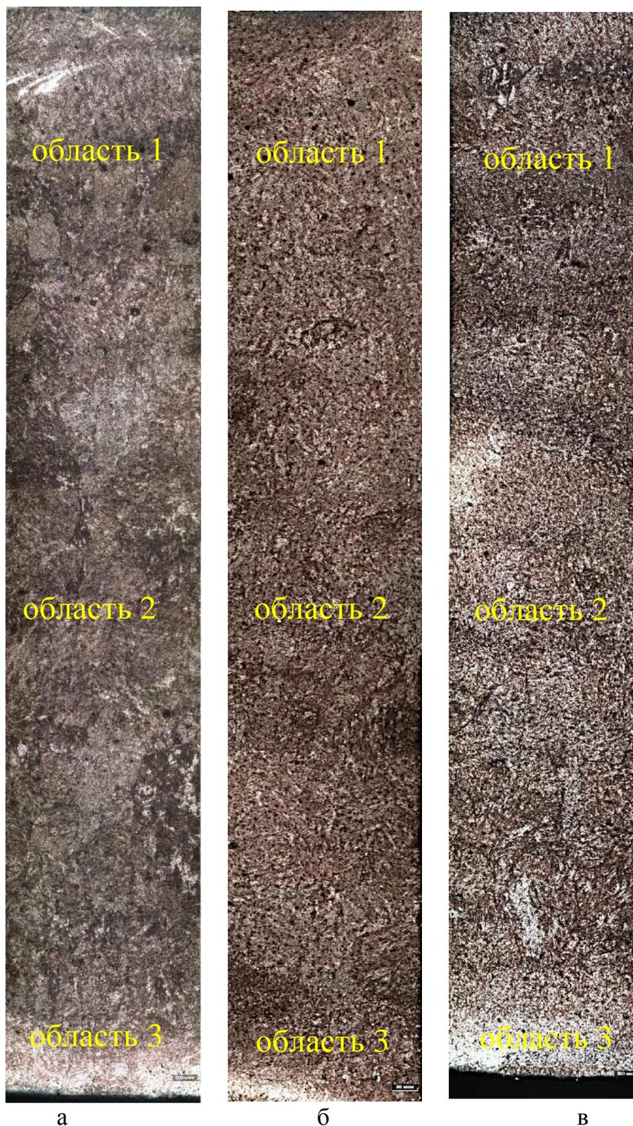
Рисунок 4.31 – Общий вид микроструктуры образцов TRIP-стали, изготовленных методом 3D-печати, в зависимости от энергосиловых параметров обработки до термической обработки : а – образец № 1-1; б - образец № 1-2; в - образец № 1-3. Световая микроскопия, х 50
