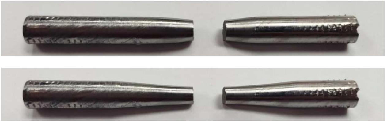
Рисунок 3.1 – Характерный вид образца после испытания на разрыв с различной скоростью деформации
