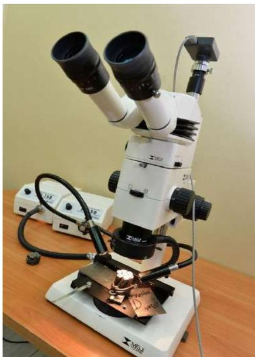
Рисунок 4.5 – Анализатор стереоизображений поверхности твердых тел на базе стереомикроскопа MeijiTechno RZ в комплекте с программой анализатором изображений Thixomet PRO
