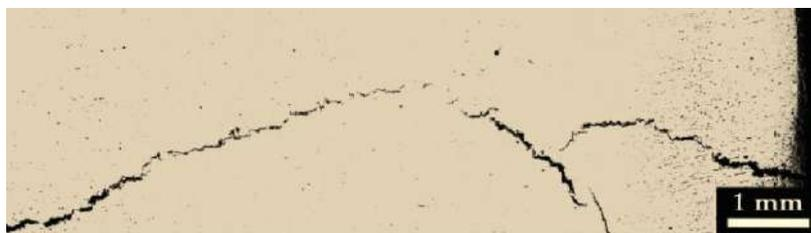
Рисунок 6.4 – Трещина в центре поверхности поперечного сечения образца
