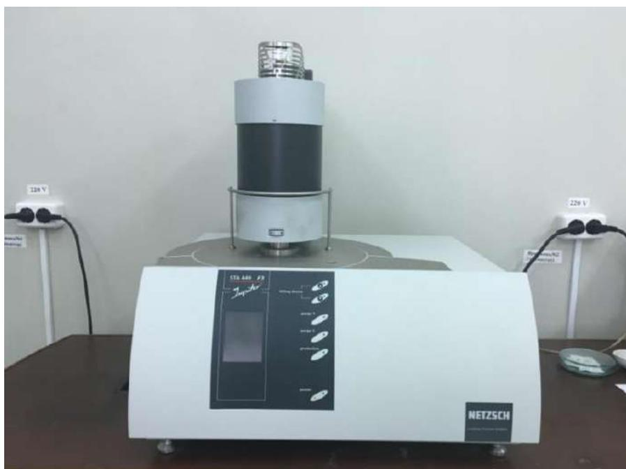
Рисунок 4.7 – Прибор синхронного термического анализа STA (Jupiter 449 F3) фирмы «NETZSCH» (Германия)
