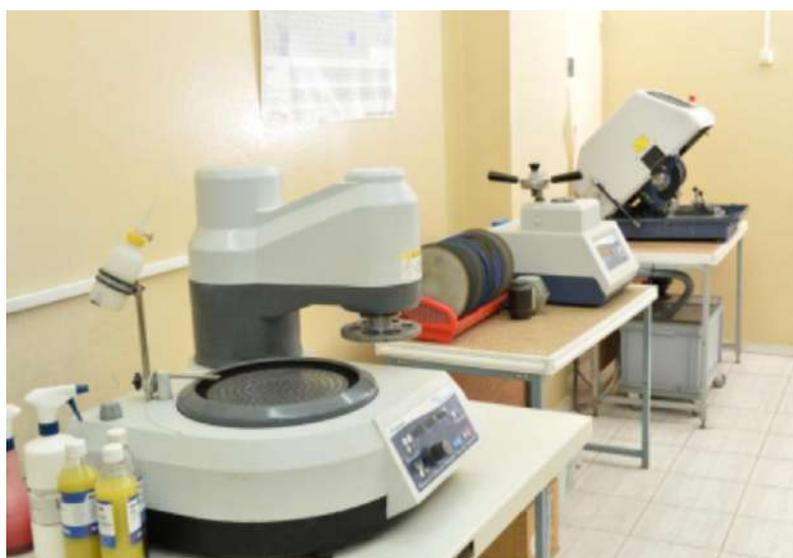
Рисунок 4.3 – Оборудование для пробоподготовки экспериментальных образцов: станок отрезной DeltaAbrasiMet 4000 Buehler, прецизионный отрезной станок IsoMet 4000 Buehler, шлифовально-полировальный станок Phoenix 4000VBuehler, запрессовочный пресс Simplimet 1000 Buehler
