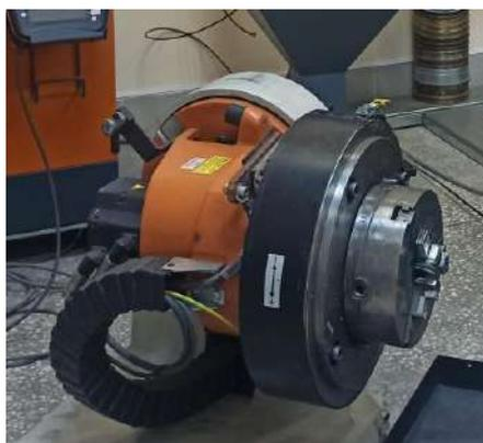
Рисунок 2.2 – Двухосевой позиционер KUKA DKP-400
