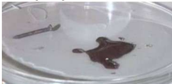
Рис. 2. Результаты опыта по взаимодействию железного гвоздя и железного порошка с раствором \text{CuSO}_4
