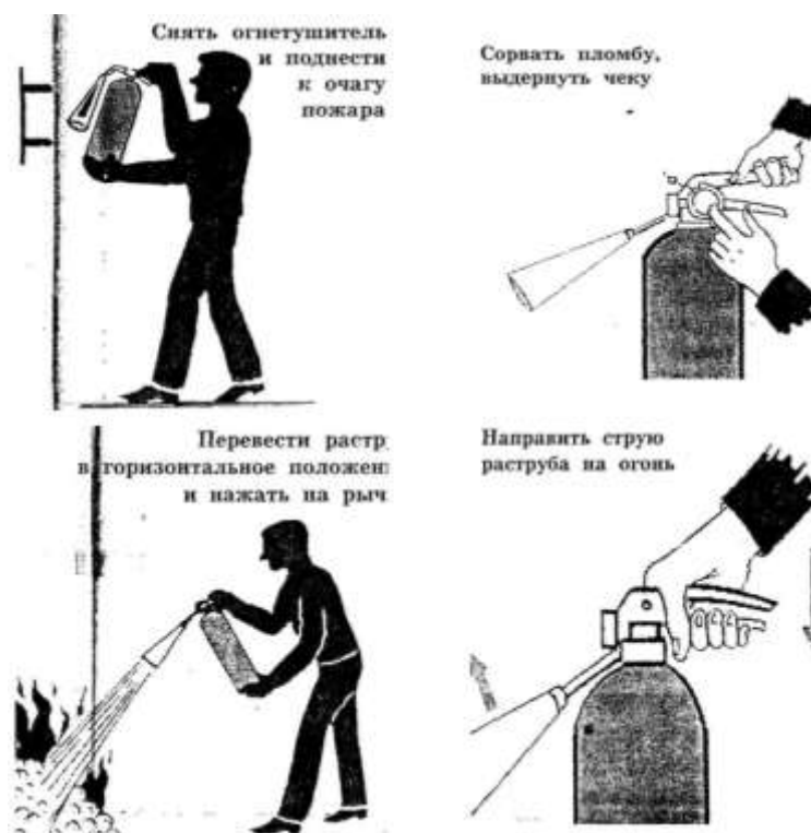
Рис. 3. Приведение в действие ручного углекислого огнетушителя.
