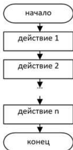
Рис.28 Блок-схем для реализации линейного алгоритма
