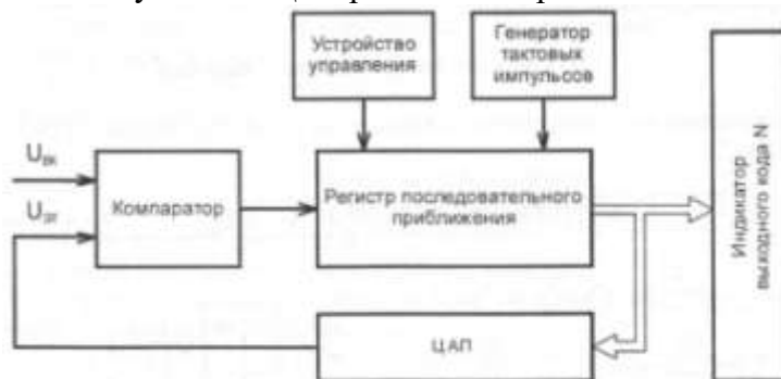
Рис. 30. Структурная схема одного канала АЦП последовательного приближения
