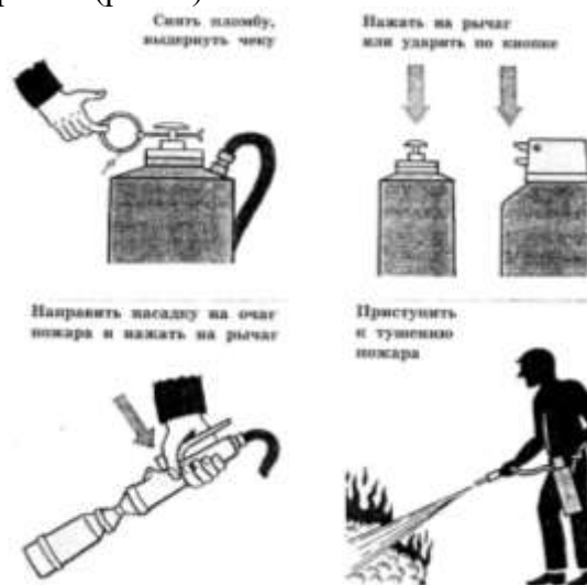
Рис.1. Приведение в действие воздушно-пенного огнетушителя.
