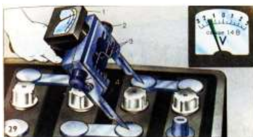
Рисунок 6 Измерение напряжения аккумулятора под нагрузкой пробником Э108
