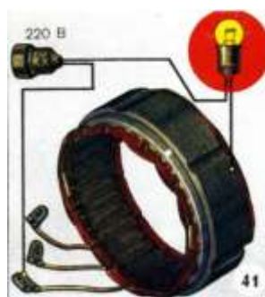
Рисунок 16 Проверка обмотки статора на замыкание с корпусом
