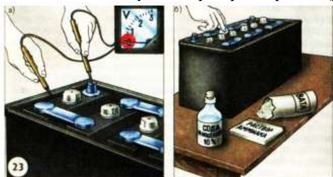
Рисунок 1 Определение (а) и устранение (б) утечки тока на мастике
