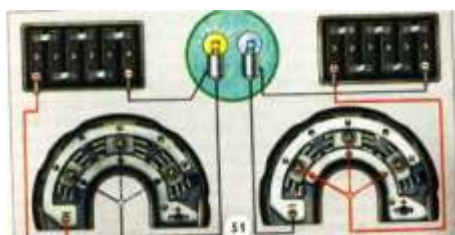
Рисунок 25. Проверка диодов минусовой шины выпрямительного блока типа ВБГ прямым (слева) и обратным (справа) включением шины в электрическую цепь
