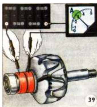
Рисунок 14 Измерение силы тока в цепи обмотки возбуждения
