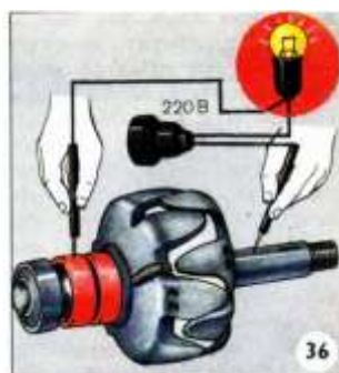
Рисунок 11 Проверка обмотки возбуждения на замыкание с корпусом
