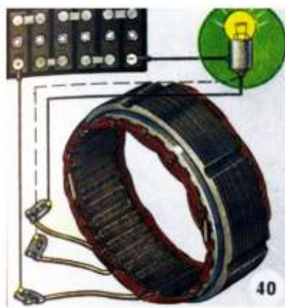
Рисунок 15 Проверка обмотки статора на обрыв
