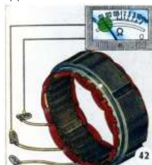
Рисунок 17 Измерение сопротивления фаз обмотки статора омметром
