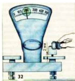
Рисунок 8. Проверка пружин щеток генератора на весах
