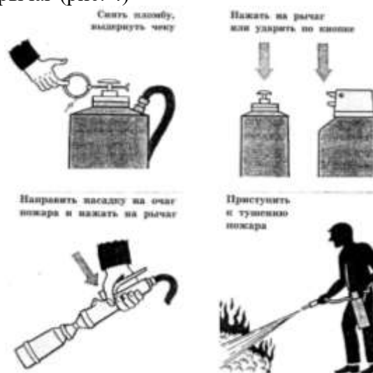
Рис.1. Приведение в действие воздушно-пенного огнетушителя.
