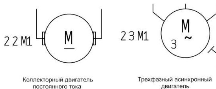
Рис. 1. Принципиальные схемы электродвигателей.
