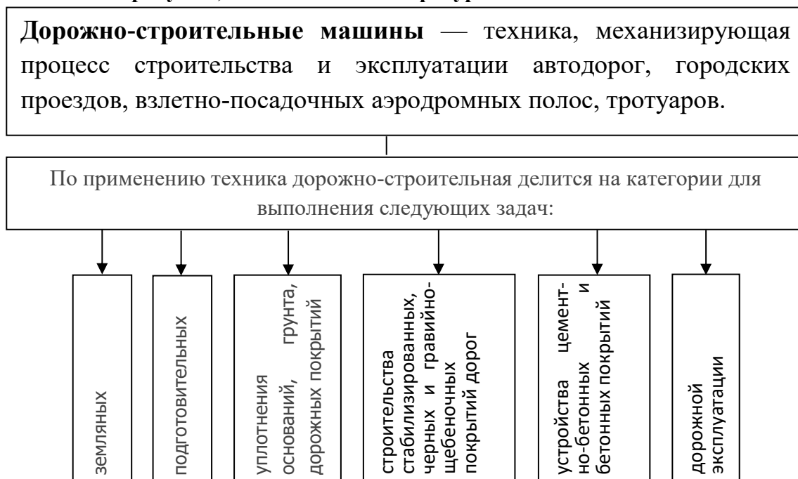
Рисунок 4 – Классификация дорожно-строительных машин
