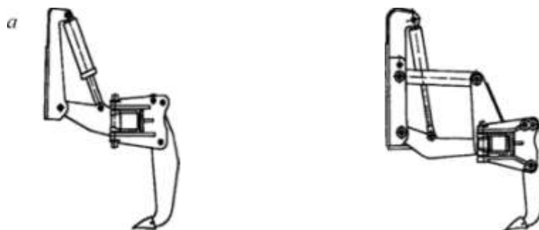
Рисунок 1.7 - Схемы устройства навесных рыхлителей: а - радиальная (трехзвенная); б - параллелограммная (четырёхзвенная)
