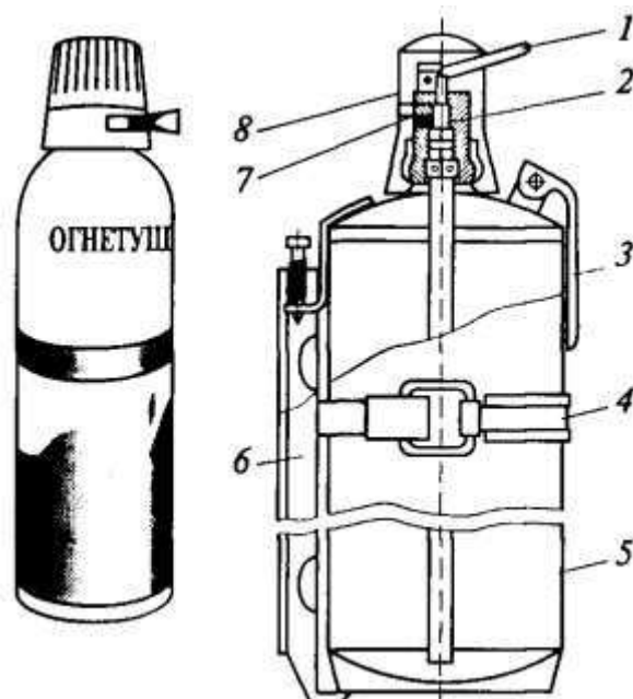
1 — пусковой рычаг; 2 — запорная головка; 3 — рукоятка; 4 — крепление; 5 — баллон; 6 — кронштейн; 7 — распиливающее устройство; 8 — предохранительный колпак Рисунок 2 - Хладоновый огнетушитель ОУБ-3А (ОУБ-7А)
