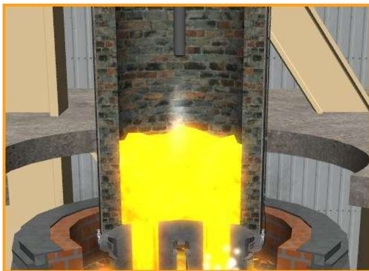
Рисунок 18. Продувка кислородной фурмой
