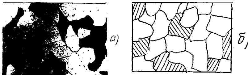
Рис. 1. Микроструктура (а) и схема (б) доэвтектоидной стали
