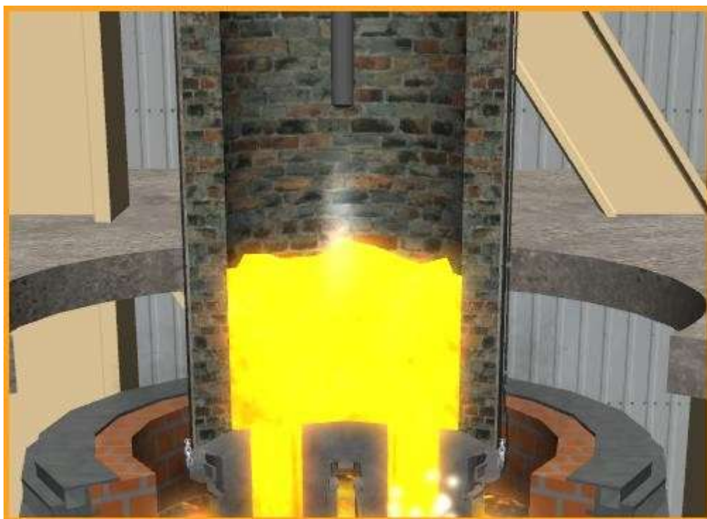
Рисунок 18. Продувка кислородной фурмой
