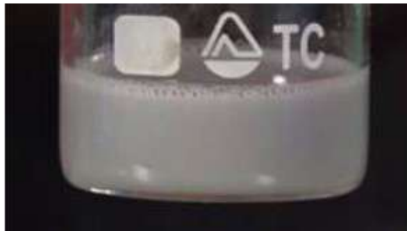
Рис. 3. Разложение пероксида водорода под действием катализатора MnO_2
