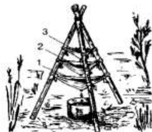
Рис. 15. Фильтрование воды: 1 — древесный уголь; 2 — песок; 3 — трава
