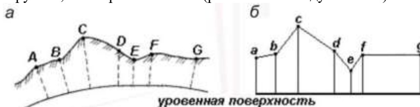
Рисунок 3.2. Вертикальный разрез (а) и профиль (б) местности
