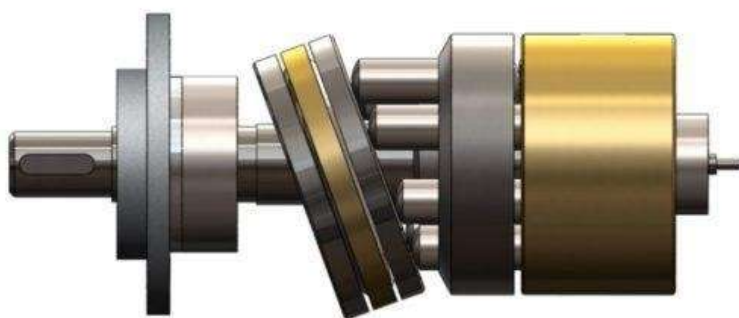
Аксиально-поршневой с наклонным диском (шайбой)
