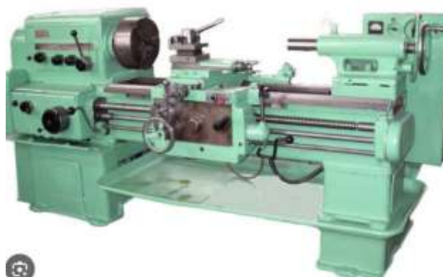
Рисунок 2 – Общий вид токарно-винторезного станка
