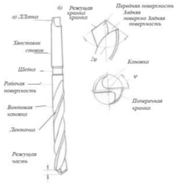
Рис.1. Части и элементы спирального сверла
