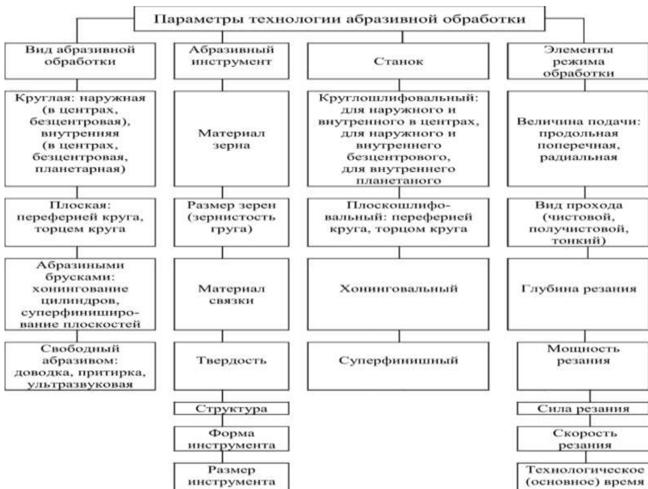
Рис.1. Схема параметров технологии абразивной обработки
