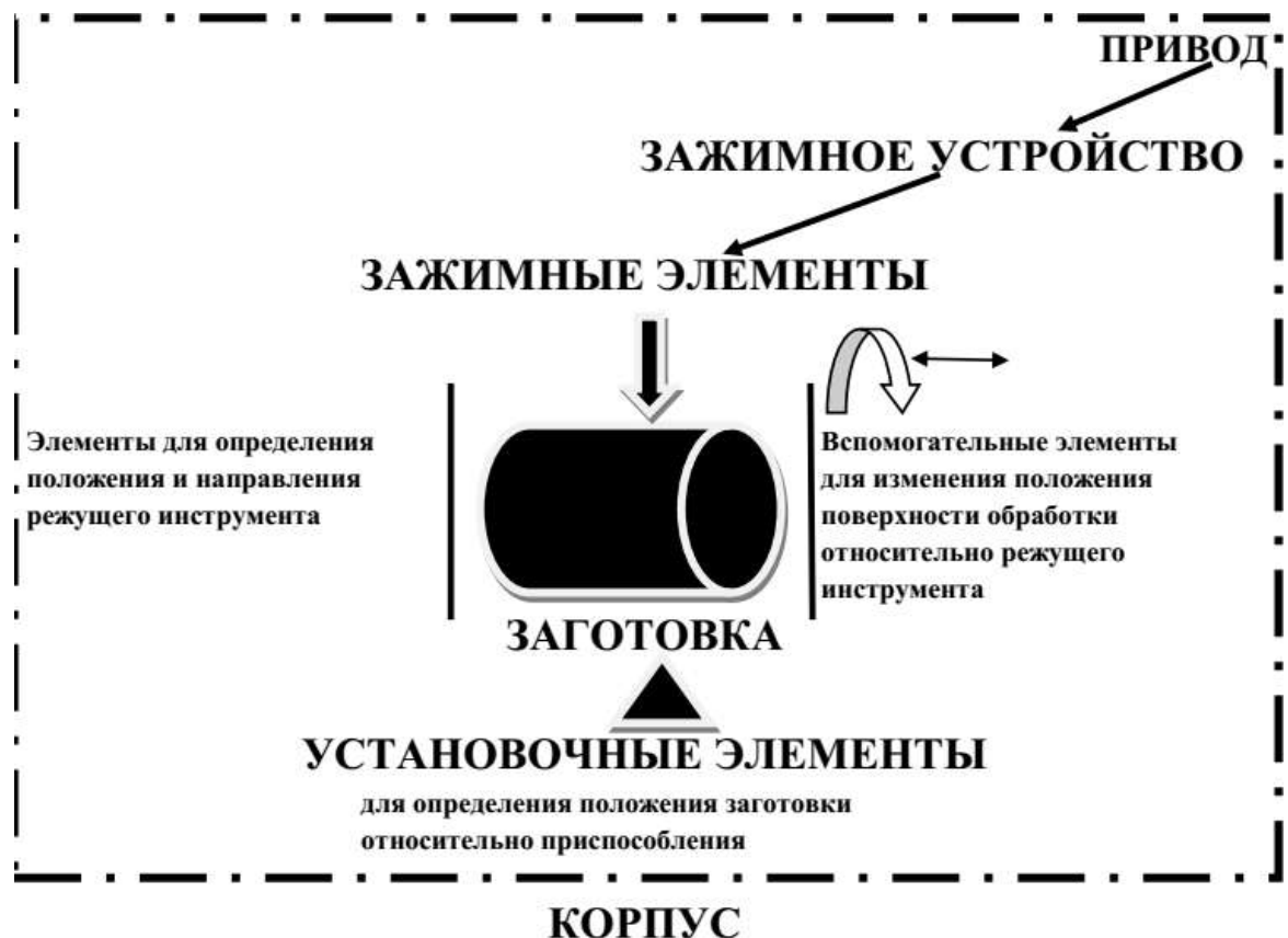
Рис. 1. Структура станочного приспособления
