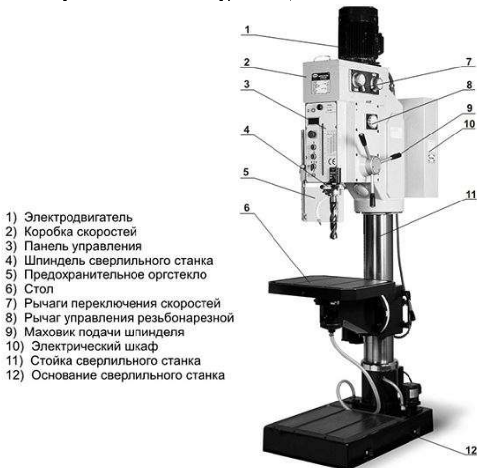
Основные узлы сверлильного станка
