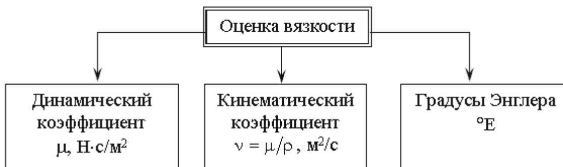
Рисунок 3 – Способы оценки вязкости жидкости
