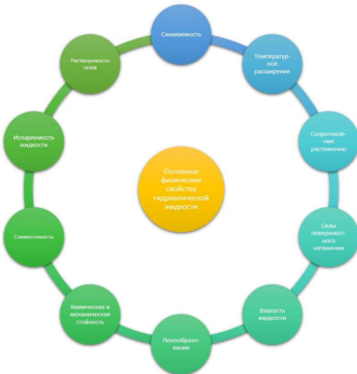
Рисунок 4 – Основные физические свойства гидравлической жидкости
