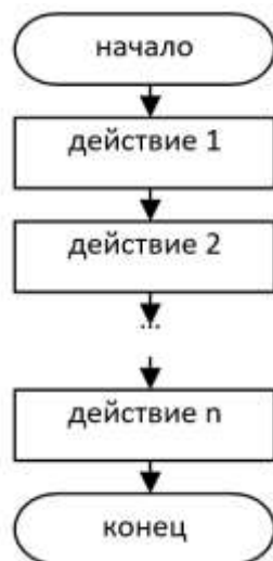
Рис.28 Блок-схем для реализации линейного алгоритма
