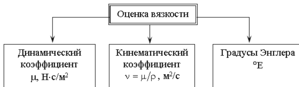
Рис. 1.8. Способы оценки вязкости жидкости
